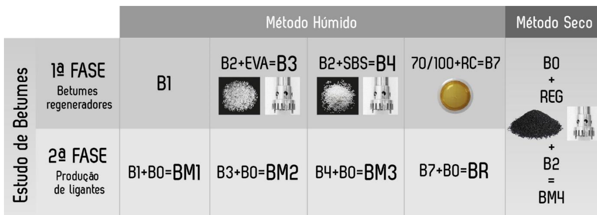
Figura 3.18 – Esquema de produção dos betumes regeneradores e ligantes
