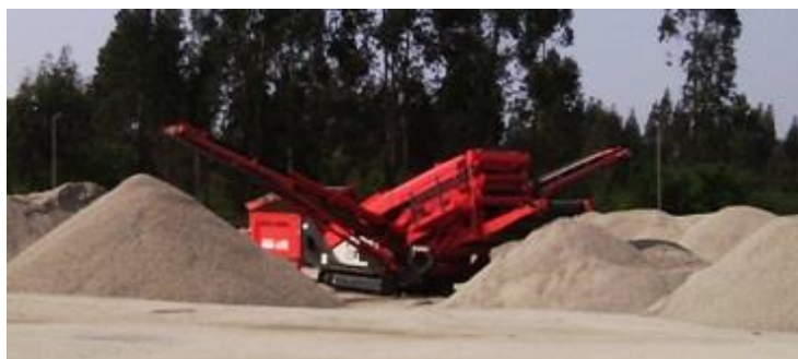
Figura 3.4 – Classificador utilizado para separação do MF em duas frações
