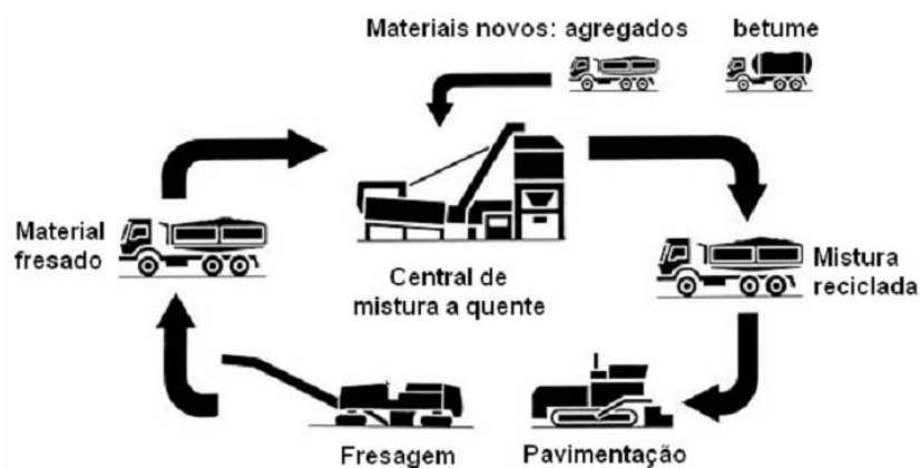
Figura 2.8 – Esquema de reciclagem a quente em central (adaptado de Wirtgen, 2003)
