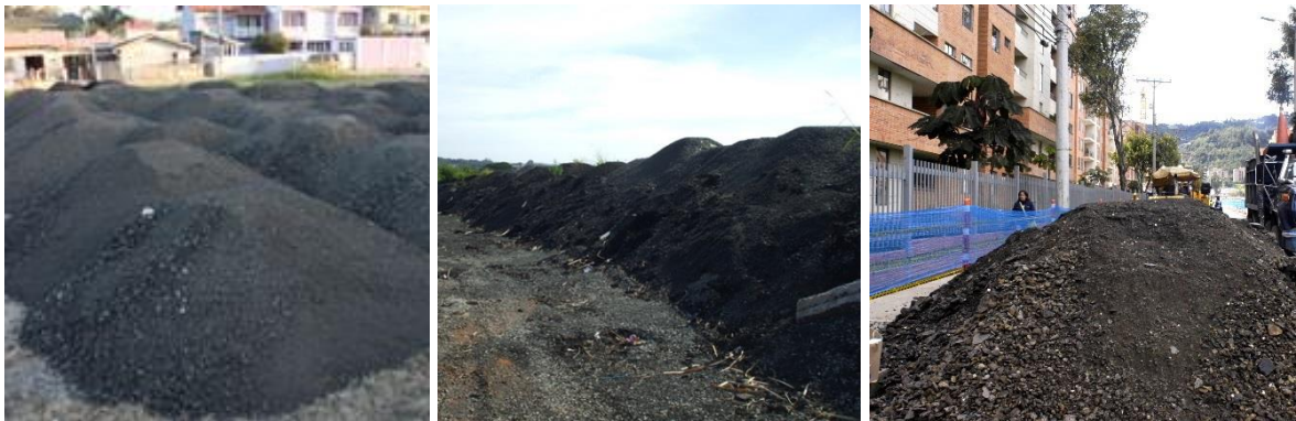
Figura 2.1 – Resíduos de pavimentos flexíveis
