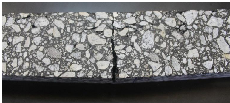
Figura 4.34 – Degradação por fadiga duma das vigas ensaiadas
