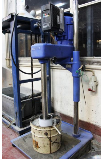
Figura 3.10 – Dispersador de alto corte IKA ULTRA TURRAX T65
