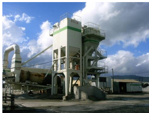
Figura 2.7 – Central de produção de misturas betuminosas
