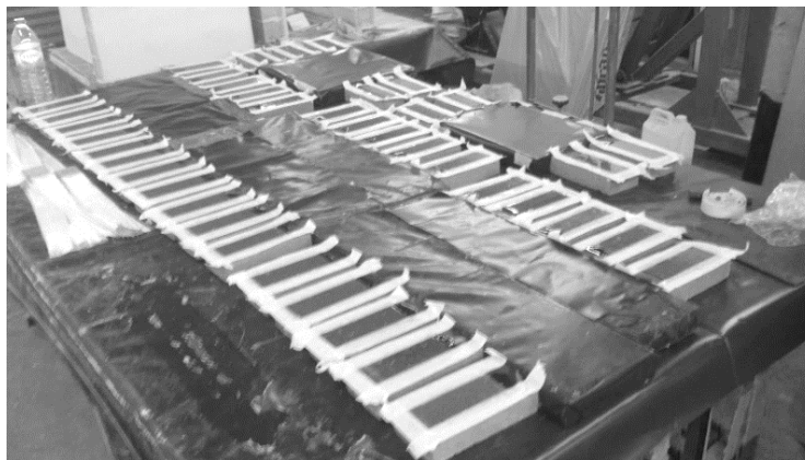
Figura 19 - Provetes de tijolo prontos para aplicação do primário.
