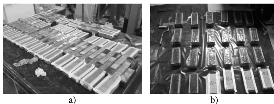
Figura 24 - Preparação de provetes: a) Aplicação do GFRP em tijolos; b) Aplicação do CFRP em betão.
