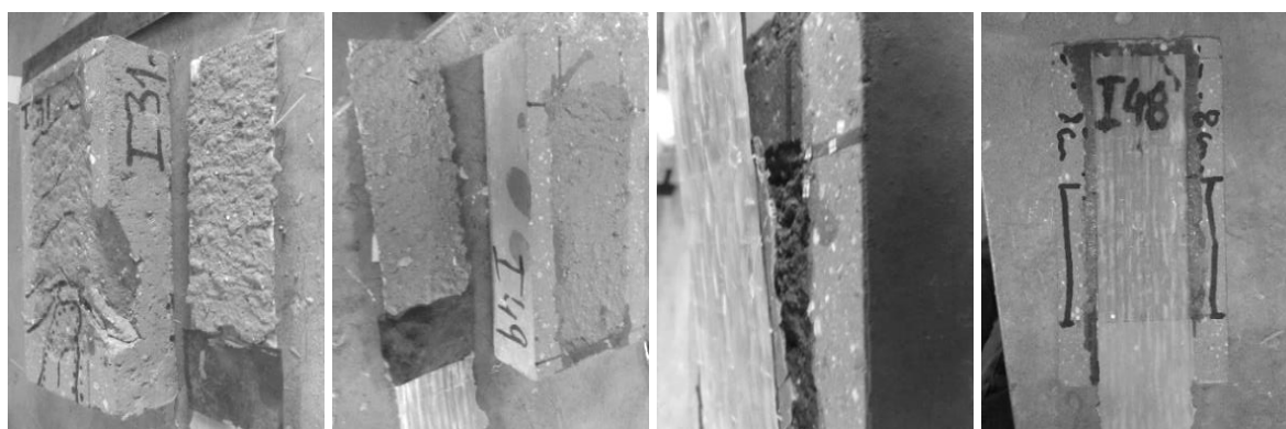
Figura 50 - Modos de rotura típicos dos ensaios dinâmicos para diferentes velocidades de deformação, com arrancamento total ou parcial do reforço GFRP.
