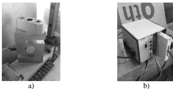
Figura 44 - Registo do perfil de Força: a) VETEK VZ101BH; b) Sistema de aquisição da Natitonal Instruments (NI).
