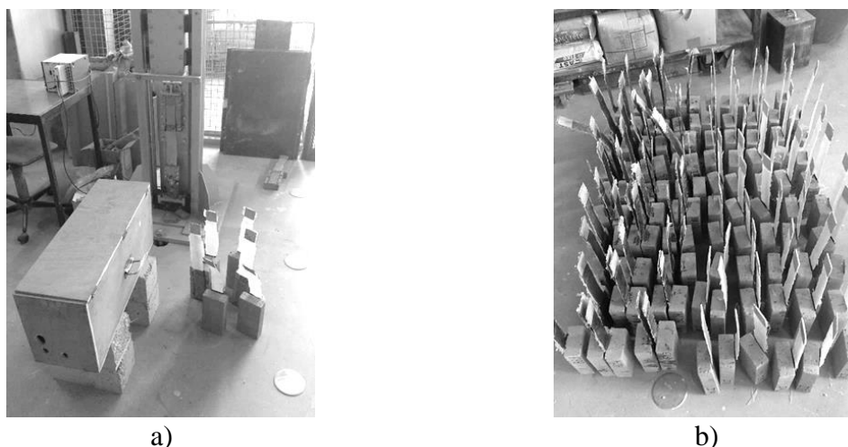
Figura 40 - Efeito das velocidades de deformação: a) Setup de ensaio; b) Provetes preparados.
