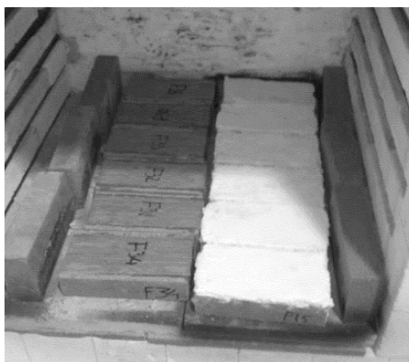
Figura 26 - Provets com e sem argamassa dispostos no forno antes de serem sujeitos a qualquer ação.
