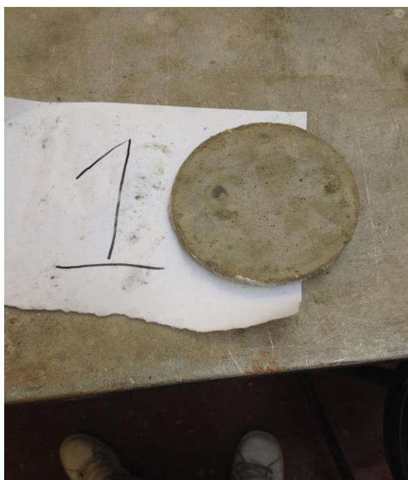
Figura 42 - Exemplo de provete usado no ensaio de condutibilidade térmica.
