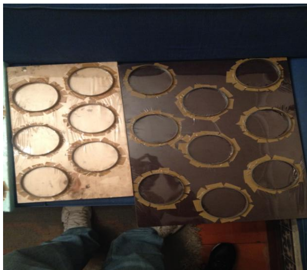
Figura 28 - Moldes utilizados para os provetes utilizados no ensaio de condutibilidade térmica.
