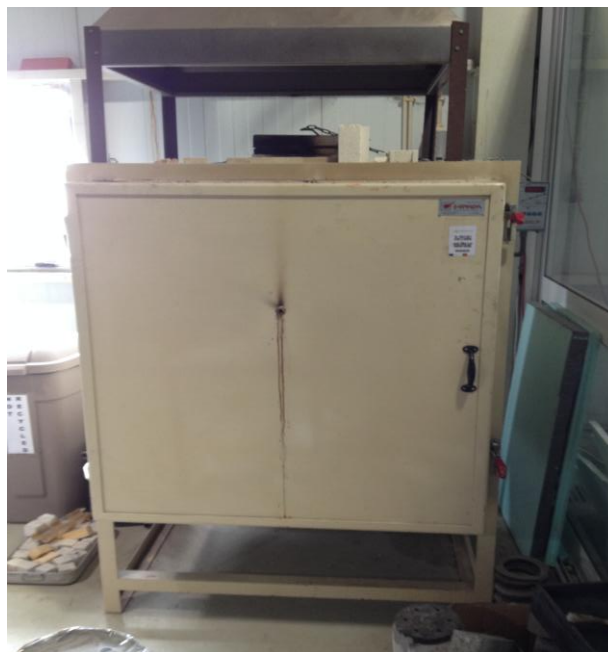
Figura 16 - Forno usado na obtenção do metacaulino aditivado.
