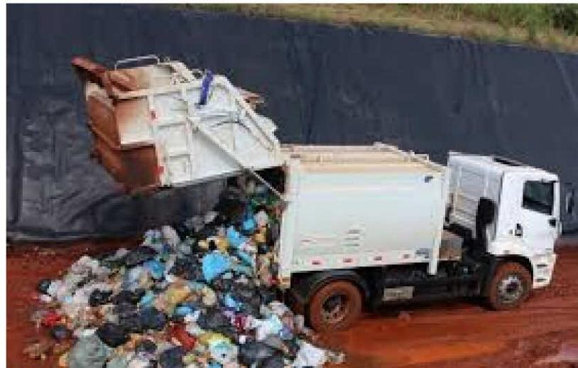
**Figura 2.4.** Exemplo de descarga de resíduos em aterro sanitário
