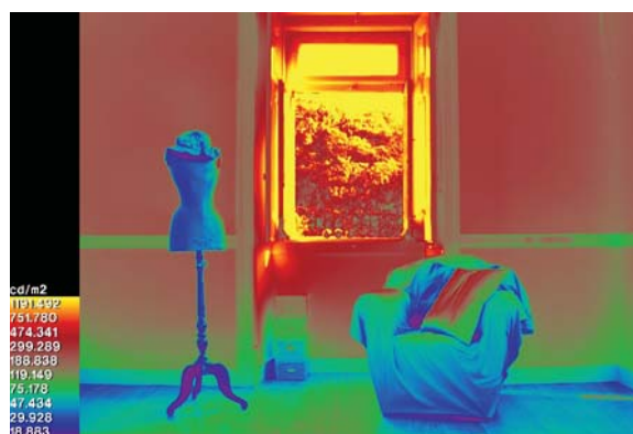
Fig.5 - Máscara de falsas cores gerada a partir de uma Imagem HDR, exibindo a distribuição de luminâncias na cena
