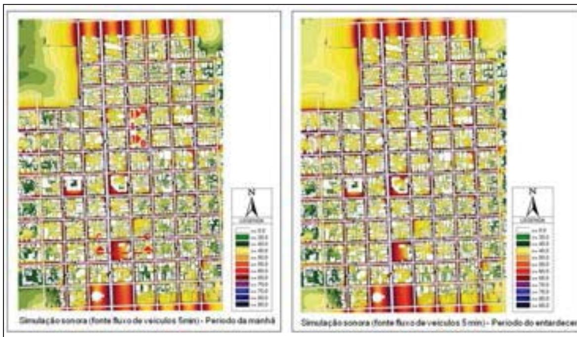
Figura 3 - Mapeamento sonoro da área de estudo para o período da manhã: dados de entrada da simulação correspondendo à fonte dada pelo fluxo de veículos 5min
