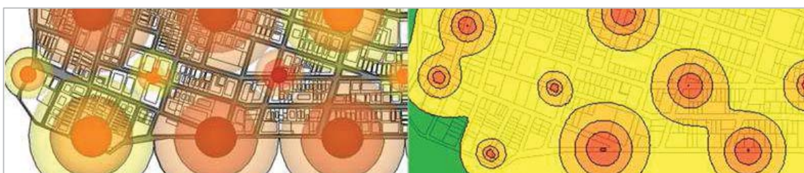
Fig. 8 No modelo do SKU (esquerda) a representação da fonte sonora não abrangeu toda a área, diferentemente do modelo do PDT (direita) que utiliza a interpolação.
