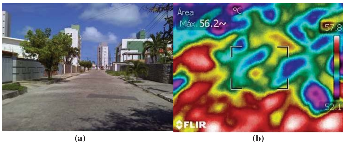
Figura 3 – Imagem digital de via pesquisada (a) e em infravermelho de ponto de medição da temperatura superficial (b)
