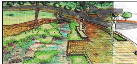
Fig. 7: vista da canaleta ecológica – aproveitamento funcional-estético e perceptivo do sistema natural de drenagem das águas pluviais.
