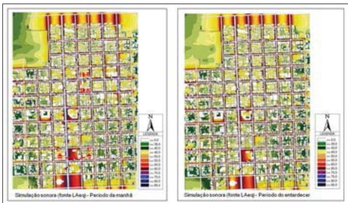
Figura 2 - Mapeamento sonoro da área de estudo para o período da manhã: dados de entrada da simulação correspondendo à emissão da fonte dada por Leq(A)
