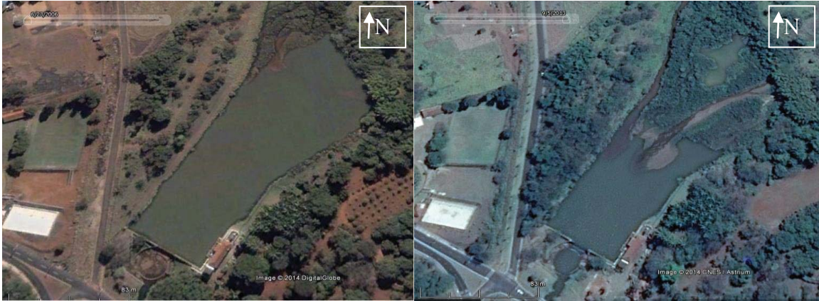
Fig. 3 Evolução da deposição de sedimentos no reservatório do Ribeirão das Cruzes. Imagens datadas de 23/06/2006 e 05/09/2013. Fonte: Google Earth. Sem escala definida.
