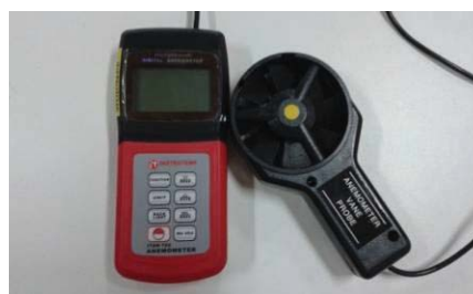
Anemômetro ITAN 720, 0,4 a 45 m/s, precisão +/- 0,2
