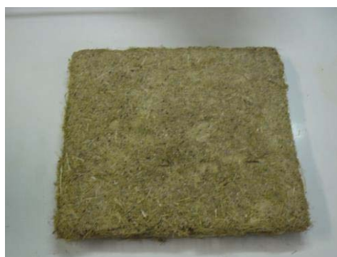
Figura 5 – Enchimento alternativo produzido a partir de fibra residual de cana-de-açúcar.
