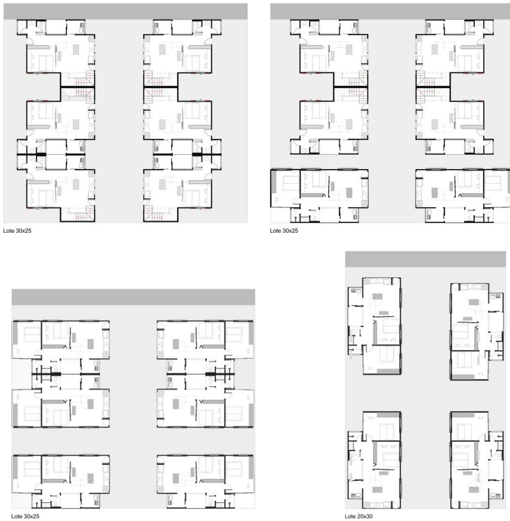
Fig. 05 Implantações em grandes lotes: acima, 6 unidades de 98 m 2 , abaixo, 6 e 4 unidades de 67 m 2
