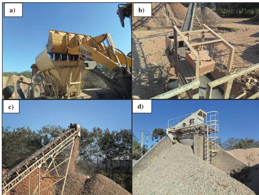
Fig. 3 Britador (a), imã (b), transportador de correia (c), peneirador (d).
