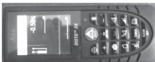
Fig. 3 Medição da inclinação diretamente sobre o terreno com o DISTO D8
