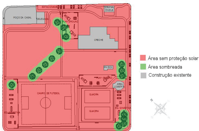
Fig. 6 Esquema da Praça Central do Conjunto Osman Loureiro mostrando as áreas com e sem proteção solar.
