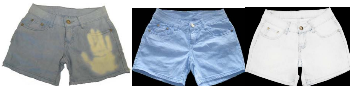
Figura 6 - Vestuário em Jeans com aplicação de microcápsulas termocrómicas que modificam a cor através da temperatura. Fonte: Carvalho, 2009.
