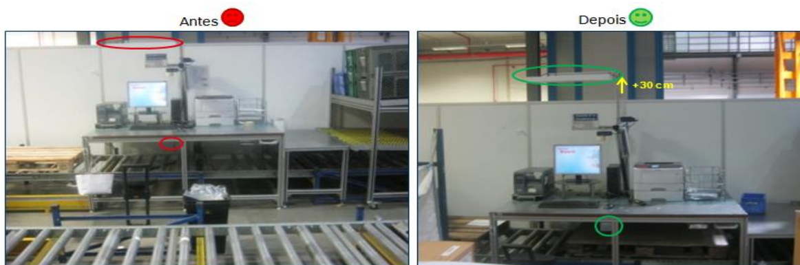
Figura 131 - Implementação do interruptor e subida da lâmpada PT6
