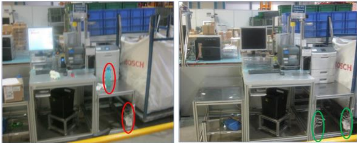
Figura 134 - Implementação de suportes no PT2
