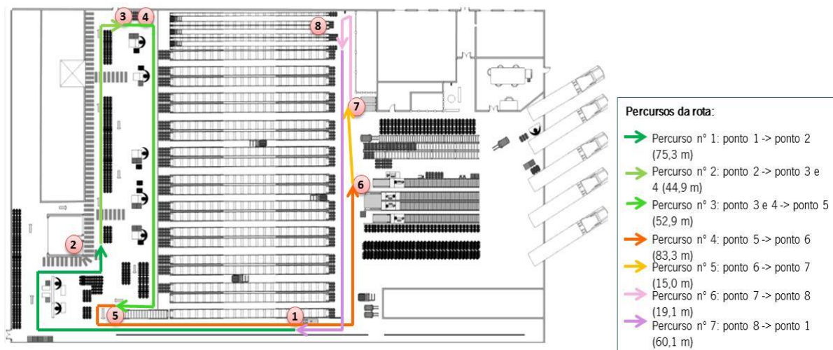
Figura 54 - Diagrama de fluxo do milk-run de acordo com a IT atual
