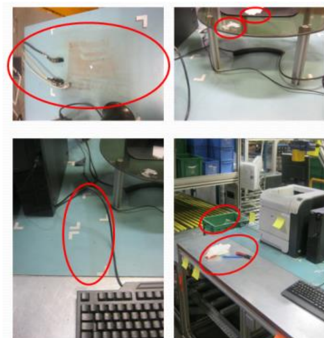
Figura 116 - Marcações desatualizadas e evidência de lixo no PT3
