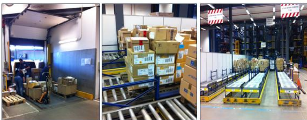
Figura 34 - a) Processo de descarga no cais 3 b) Paleta de material MNV numa rampa c) Paletes distribuídas pelas rampas de roletes
