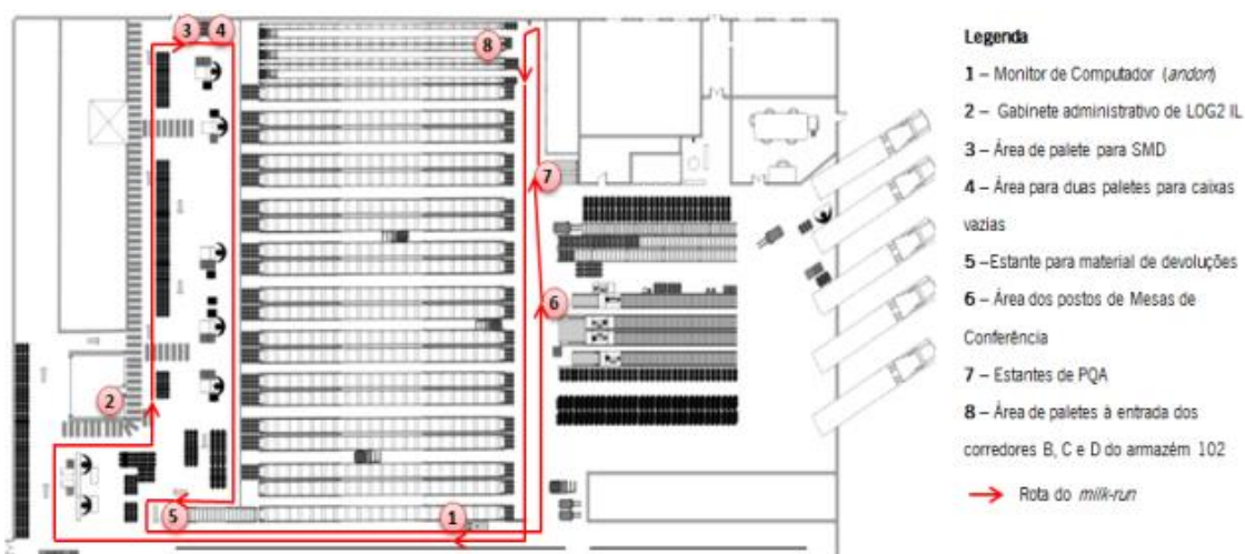
Figura 42 - Diagrama do fluxo do milk-run e respetivos pontos de paragem
