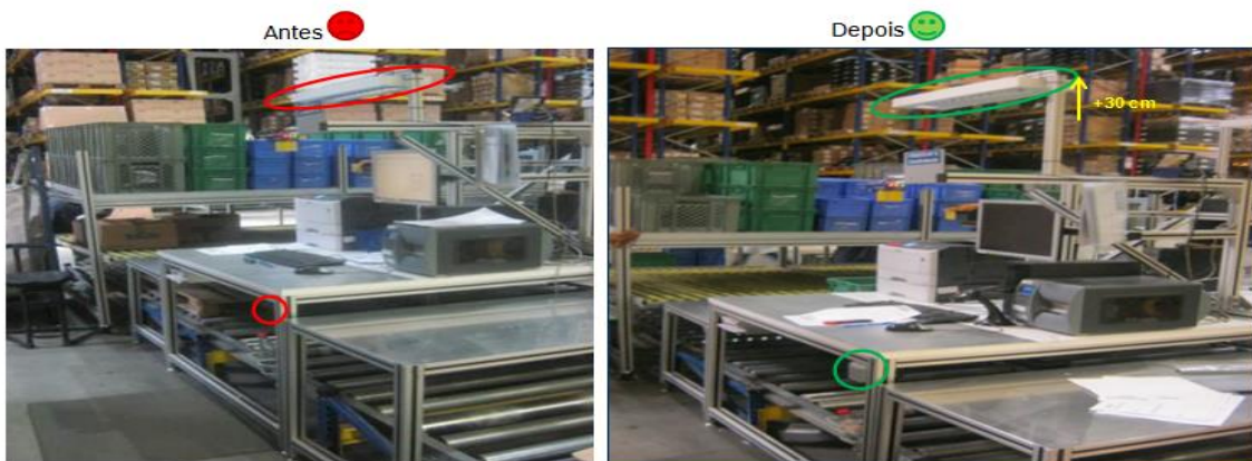
Figura 130 - Implementação do interruptor e subida da lâmpada PT5
