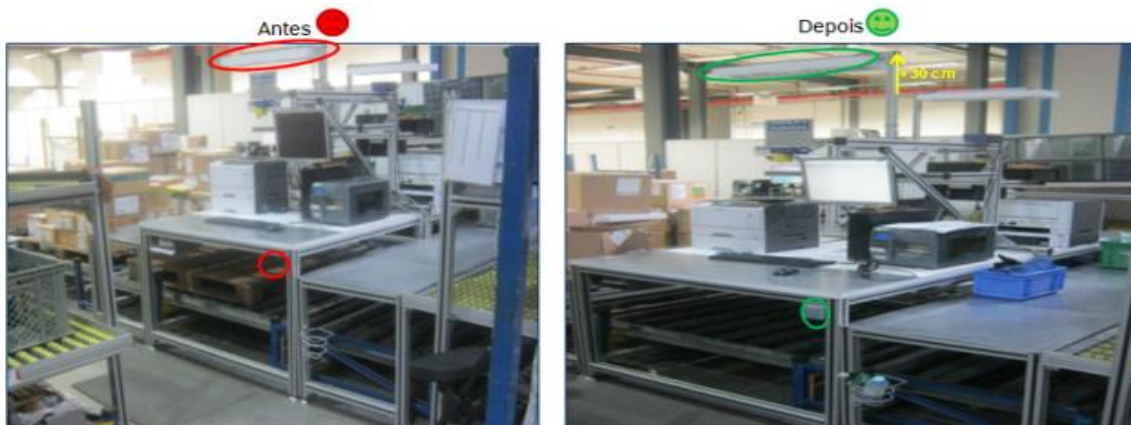
Figura 129 - Implementação do interruptor e subida da lâmpada PT4
