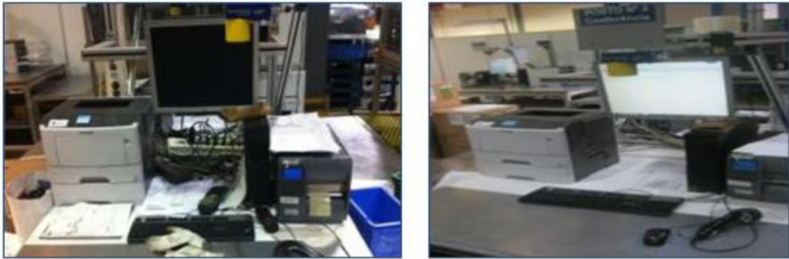
Figura 133 - Exemplo de situação antes e depois de arrumação dos fios elétricos e da aplicação dos 5S
