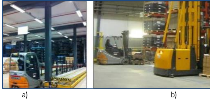
Figura 29 – Manobras dos empilhadores: a) colocação das paletes nas rampas após descarga; b) colocação das paletes nos para-paletes do armazém principal 102
