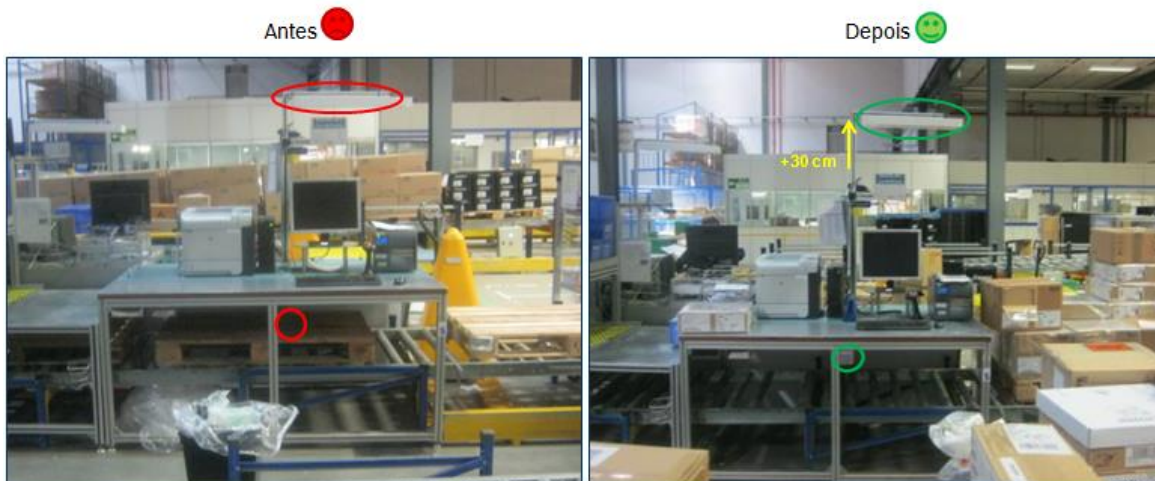
Figura 128 - Implementação do interruptor e subida da lâmpada PT3
