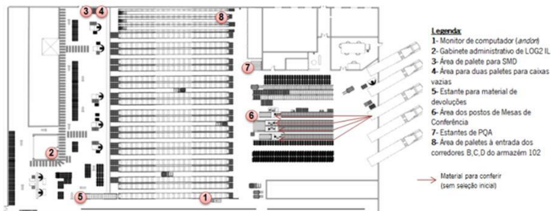
Figura 41 - Representação do fluxo de entrada do material MNV até às MC
