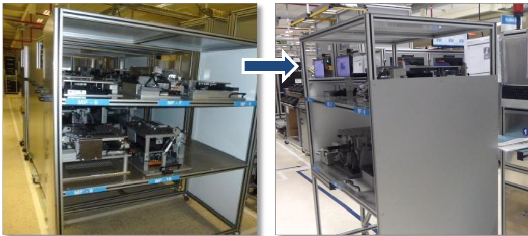
Figura 16 – Abertura de uma janela lateral para o seguro transporte do trolley para a linha de produção (BOSCH, 2015)
