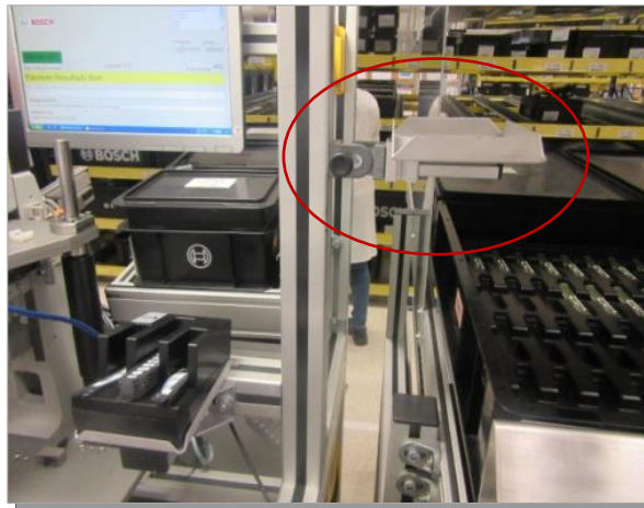
Figura 38 – Plataforma auxiliar instalada para a colocação do suporte pré-preparado com os dials (Bosch, 2015)
