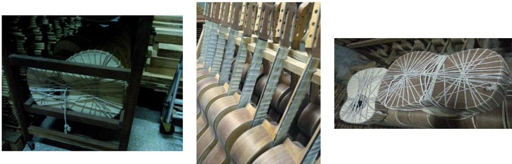
Figura 71 - Subprodutos em processo de cura-secagem da colagem
