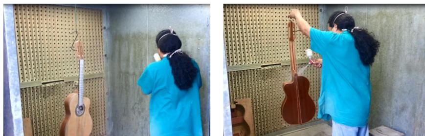
**Figura 66 - Processo de Envernização na Estufa**
