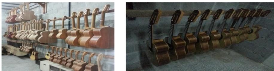
Figura 72 - Subprodutos em processo de cura-secagem do verniz
