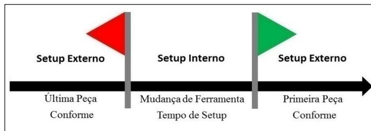
Figura 10 - Componentes do Tempo de *Setup* (Adaptado de Lopes, Neto & Pinto, 2006)
