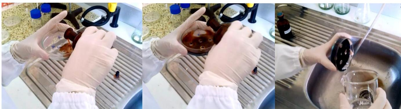
**Figura 4.** Utilização do soluto de lugol para detetar a presença de amido na placa
