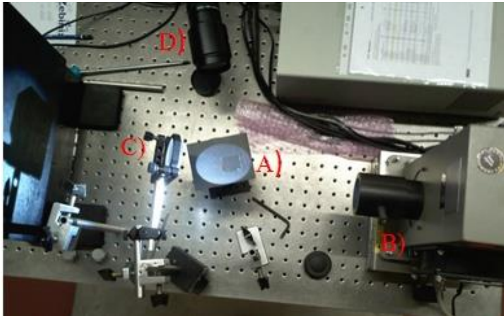
Figura 36 - Equipamento que permite medir o ângulo de contato é constituído: A) Porta-Amostras; B) Simulador Solar com lâmpada de Xénon (Oriel Corporation Stratford Connecticut, USA – Modelo 66002); C) Espelho; D) Câmara.
