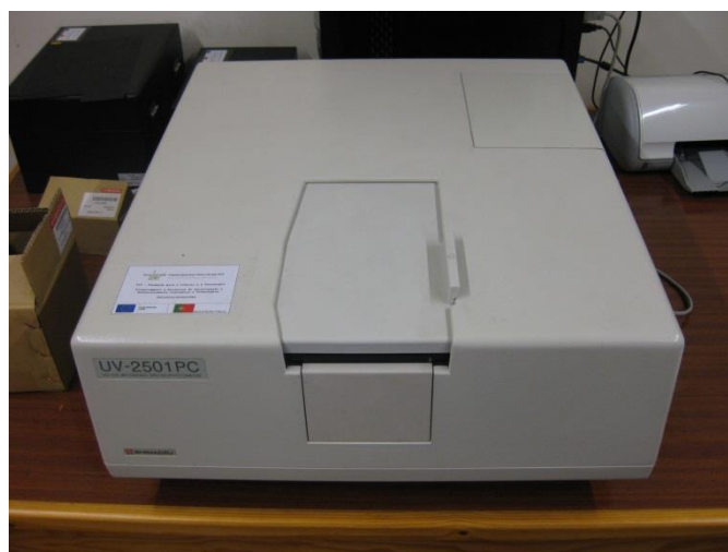
Figura 26 - Espectrofotómetro de Absorção Shimadzu, Modelo UV-2501 PC
