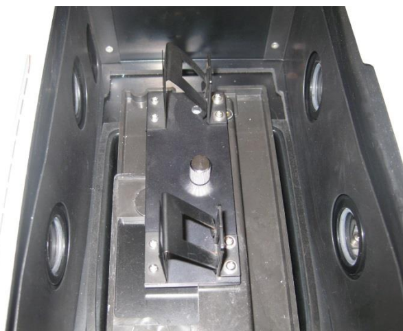
Figura 27 – Porta-substratos onde se colocam as amostras para o ensaio de transmitância
