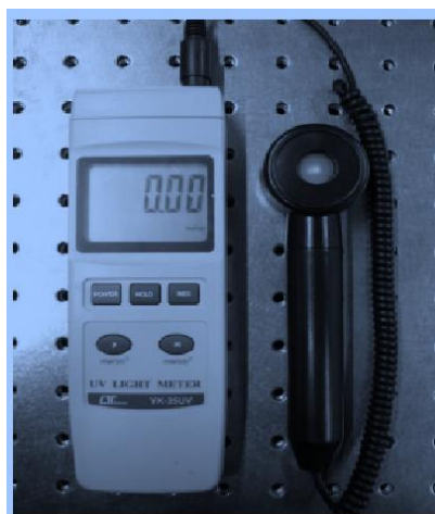
Figura 30 - Medidor de radiação UV Light Meter YK - 35 UV da Lutron
