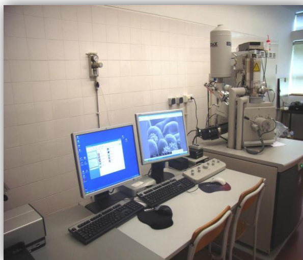
Figura 33 - Microscopia Eletrónica de Varrimento (MEV)
