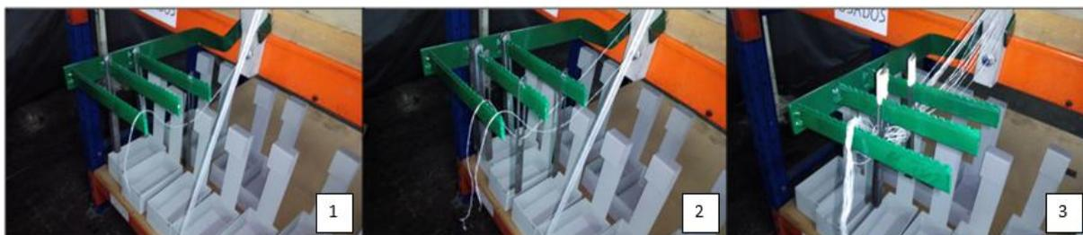
**Figura 80 - Processo de inserção das lamelas**
