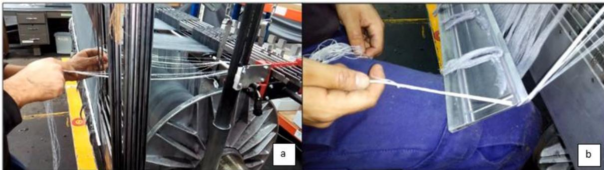
**Figura 82 - Inserção dos fios (a) Malhas (b) Pente**
