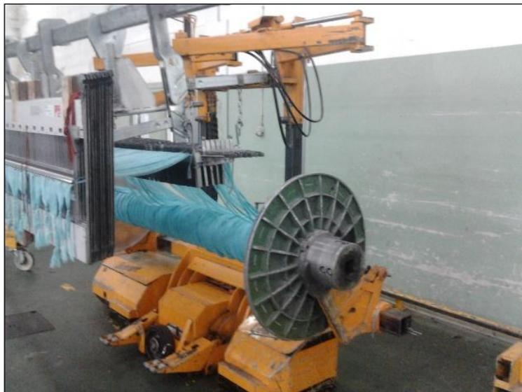
**Figura 38 - Teia colocada na máquina**
