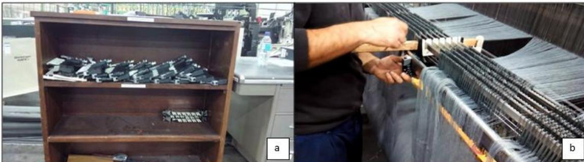
**Figura 85 - Peças separadoras (a) Stock (b) Colocação**
