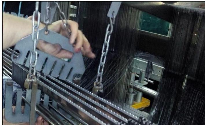
**Figura 55 - Peça desadequada nas remetedeiras**
