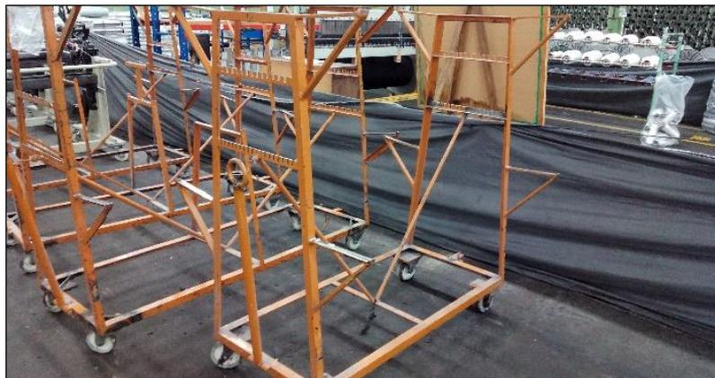
**Figura 36 - Equipamento de transporte do material auxiliar**
