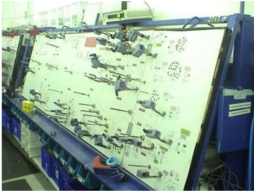
Figura 16 - Tábua de montagem com as instruções imprimidas e forquilha de auxílio à produção
