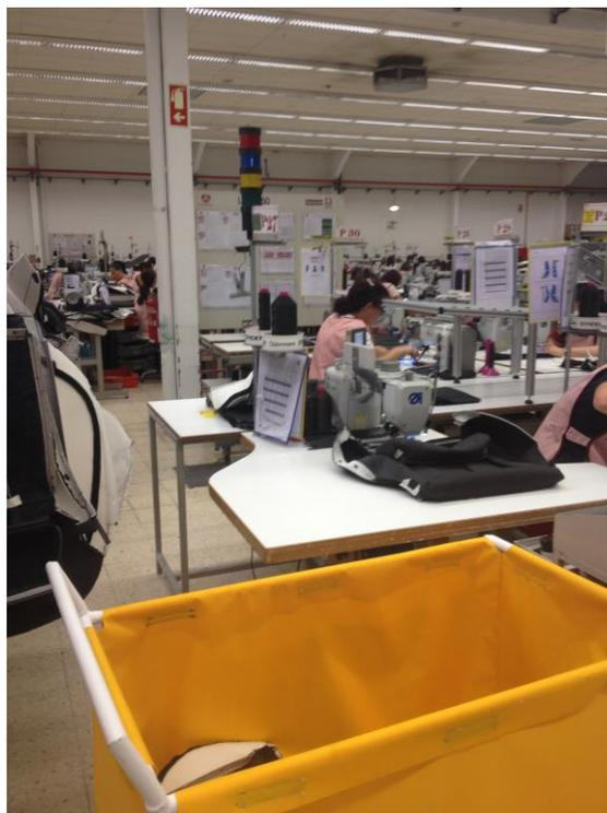
**Figura 32: Sistema Andon implementado na célula.**
