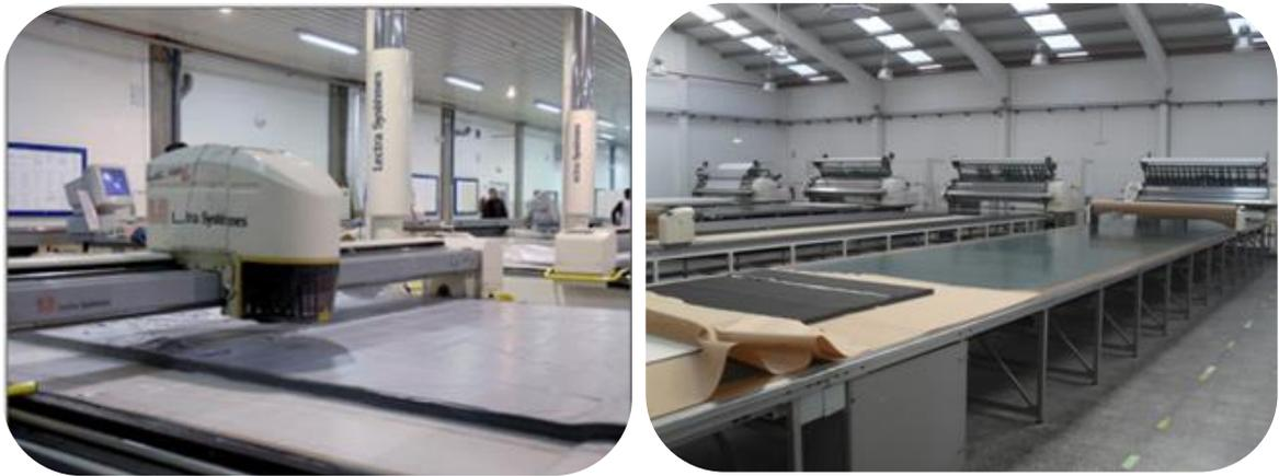
As Lectras têm associado um sistema integrado de CAD/CAM. O processo é inicializado
