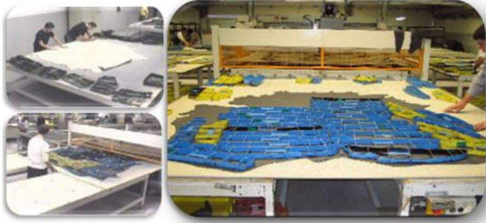
**Figura 10: Corte de Couro - Colocação dos cortantes na pele**
