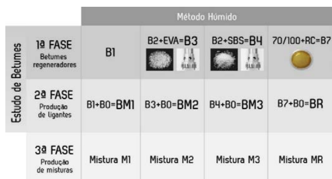
Figura 1 – Esquema de produção dos betumes regeneradores e respetivas misturas betuminosas
