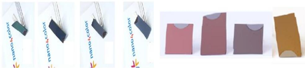
*Figura 5 - Resultados obtidos anteriormente para o projeto Nano4Color, onde é possível observar a cor vermelha correspondente ao Au (lado direito da Imagem) e a cor azul ao Ag (lado esquerdo da imagem)*
