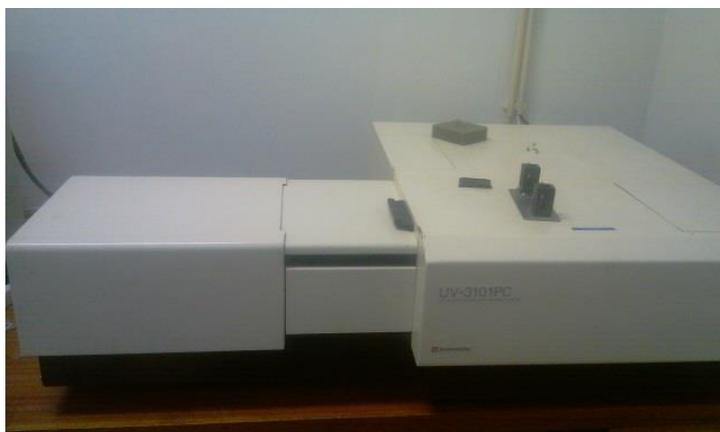
Figura 40 - Espectrofotómetro Shimadzu UV-3101 PC UV-vis-NIR
