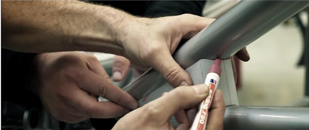
Figura 24: Imagem do fabrico de um reforço estrutural não normativo para o chassis do Peugeot™ 2008 DKR (43).
