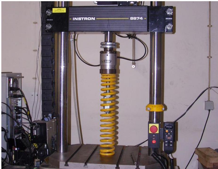
Figura 33: Imagem do ensaio de compressão de uma mola de competição.
