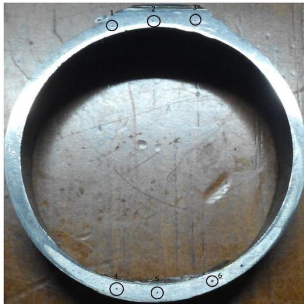
Figura 66: Imagem de amostra 2 dos cordões de soldadura com o material AWS A5.28 ER80S-B2.
