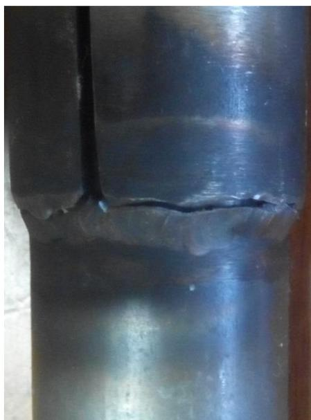
Figura 67: Imagem da fratura de fadiga verificada no provete 8.
