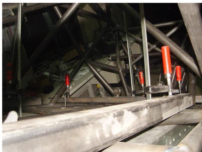
Figura 73: Imagem da fixação do chassis ao gabarito plano.
