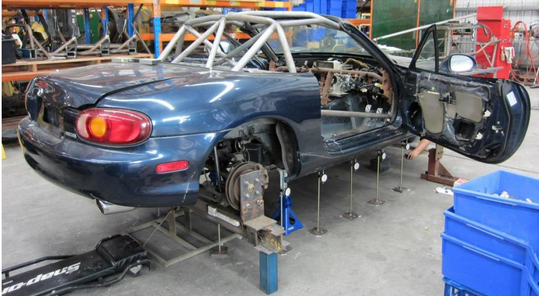
Figura 31: Imagem de um ensaio experimental de flexão de um veículo (76).
