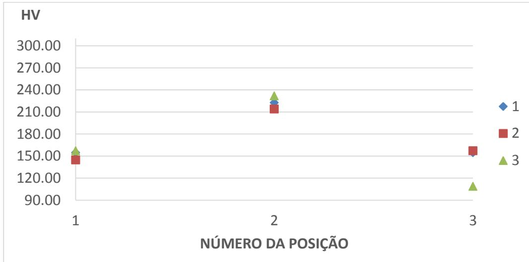
Gráfico 2: Resultados da análise de dureza às soldaduras com nível de intensidade 5.
