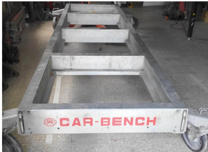
Figura 29: Base estável usada na construção dos chassis.
