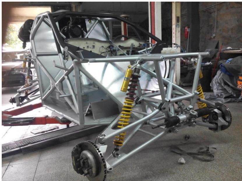
Figura 72: Imagem do chassis do veículo novo quase finalizado.
