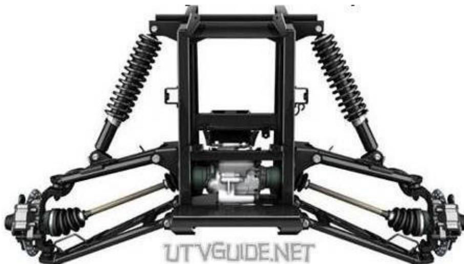
Figura 69: Imagem de um sistema de suspensão similar ao usado no eixo traseiro do novo veículo (110).
