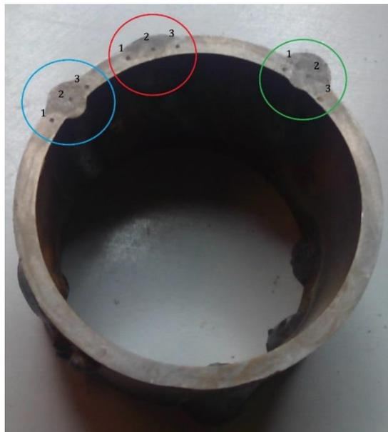
Figura 56: Imagem da amostra dos cordões realizados com intensidade de nível 4.
