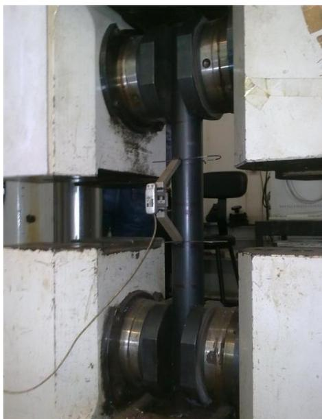
Figura 39: Imagem do ensaio destrutivo de tração.
