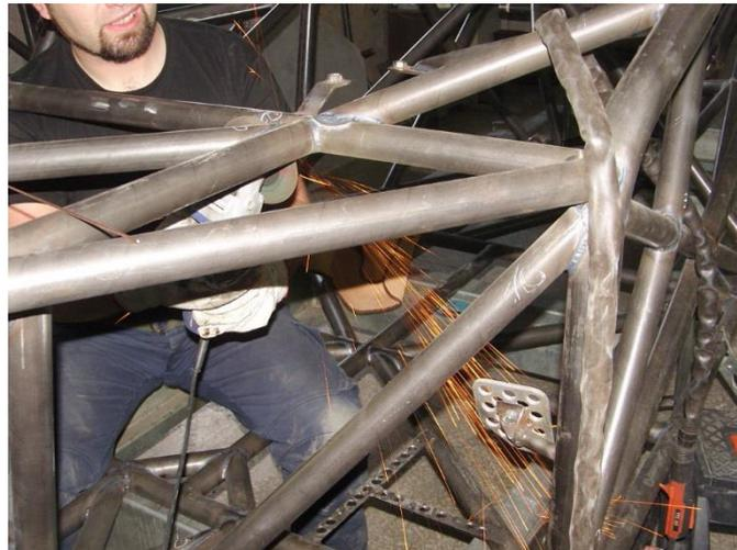
Figura 74: Imagem da reparação de um cordão de soldadura.
