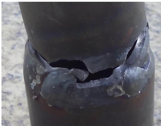
Figura 55: Imagem do segundo provete testado no primeiro ensaio de fadiga.
