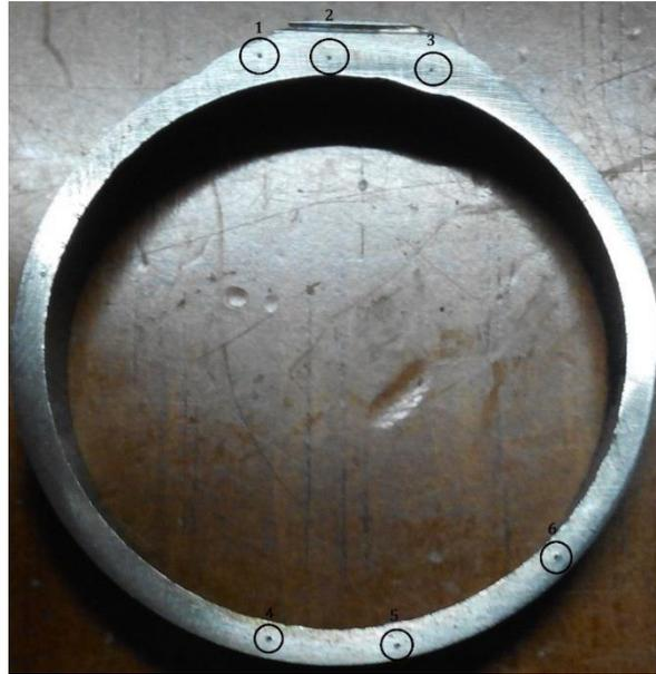
Figura 65: Imagem de amostra 1 dos cordões de soldadura com o material AWS A5.28 ER80S-B2.
