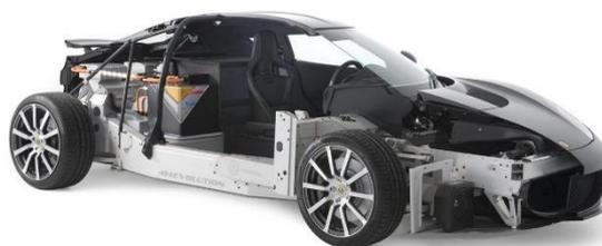
Figura 9: Imagem de um chassis em formato de plataforma de um Lotus™ (25).
