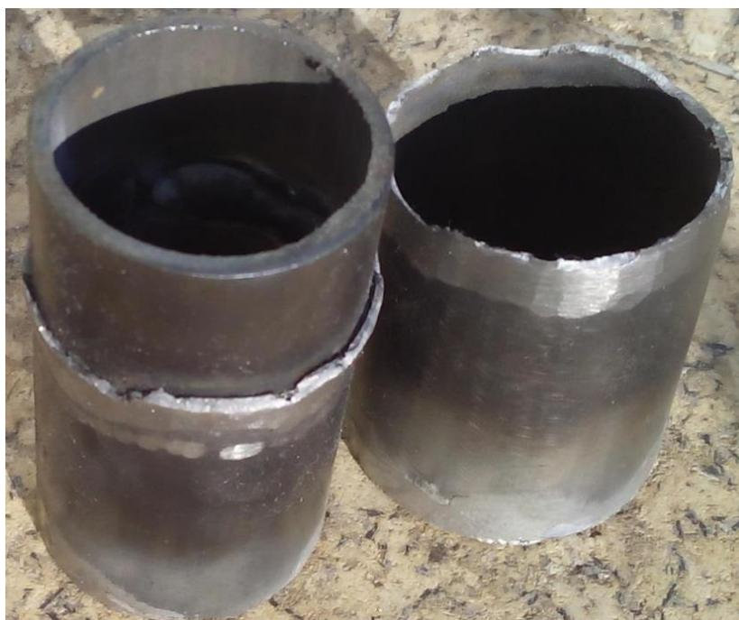
Figura 60: Imagem do quinto provete testado à fadiga.
