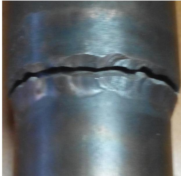
Figura 68: Imagem da fratura de fadiga verificada no provete 11.
