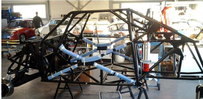
Figura 16: Imagem do chassis do Jimco Racing™ Rally Raid de motor central traseiro (37).
