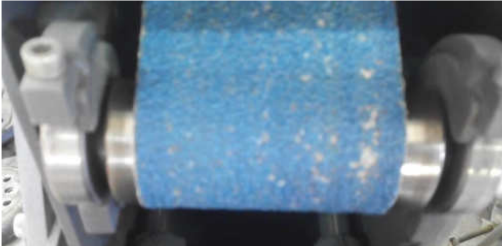
Figura 8.3: Imagem da lixa danificada.
