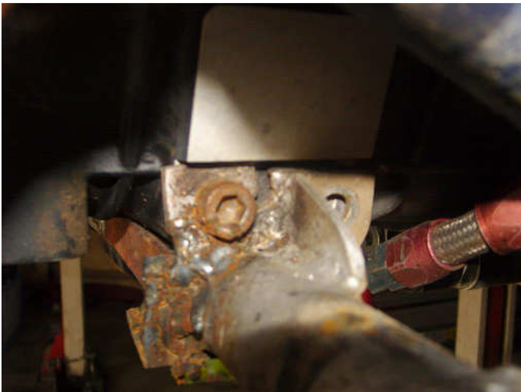
Figura 26 – Conjunto de imagens relativas aos apoios dos componentes de transmissão de potência
