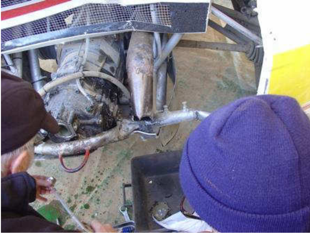
Figura 20 – Reparação da traseira para permitir o acesso à bomba de lubrificação da caixa de velocidades
