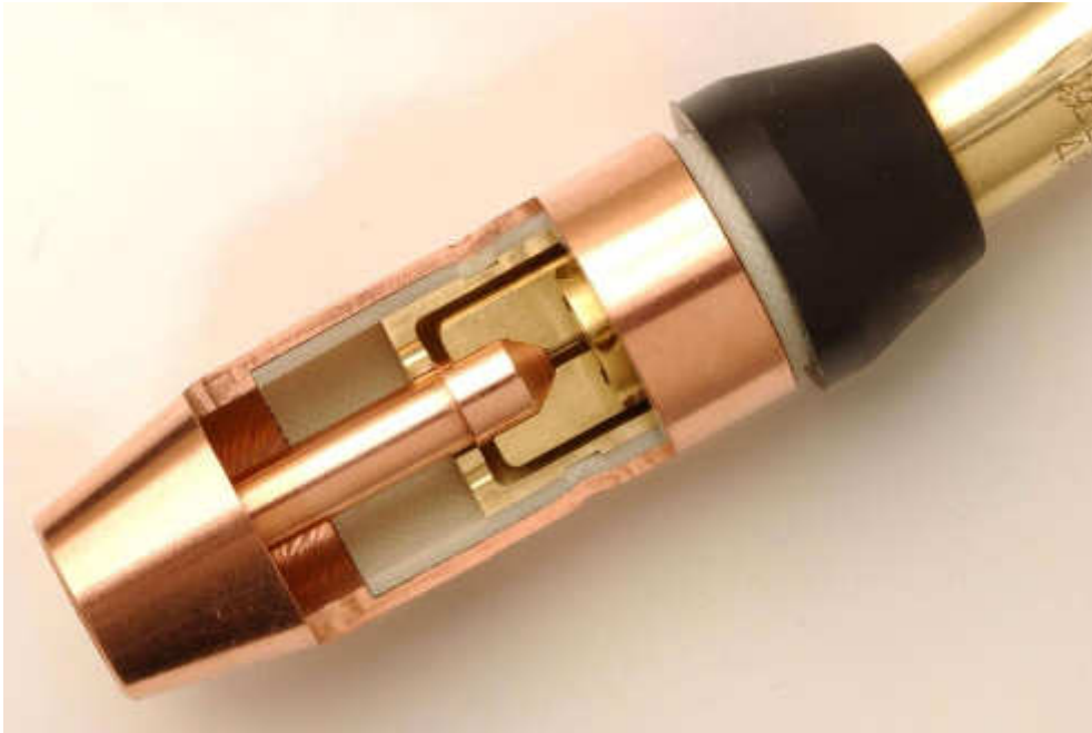
Figura 7.1: Vista do Bocal, do suporte do bico e do difusor, seccionados, expondo o bico e o elétrodo consumível de uma tocha de MIG/MAG/GMAW (113).
