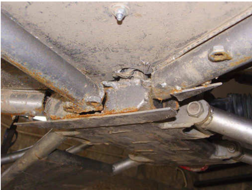
Figura 23 – Dano total da secção frontal
