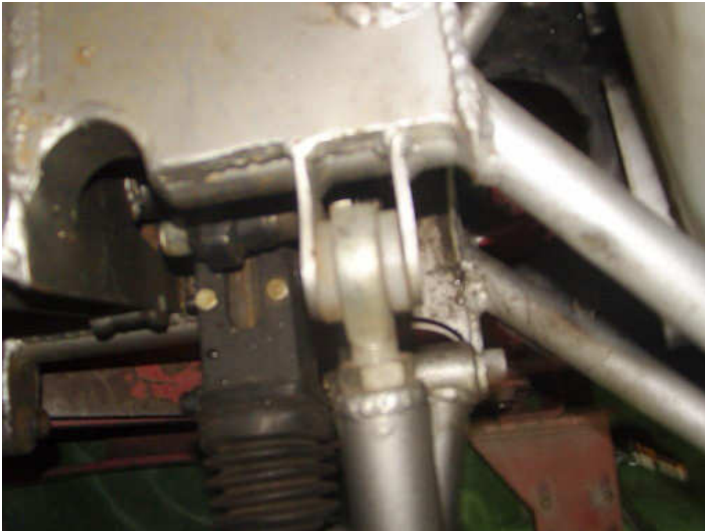
Figura 18 – Flexão observada num dos apoios dos braços triangulares superiores da suspensão frontal
