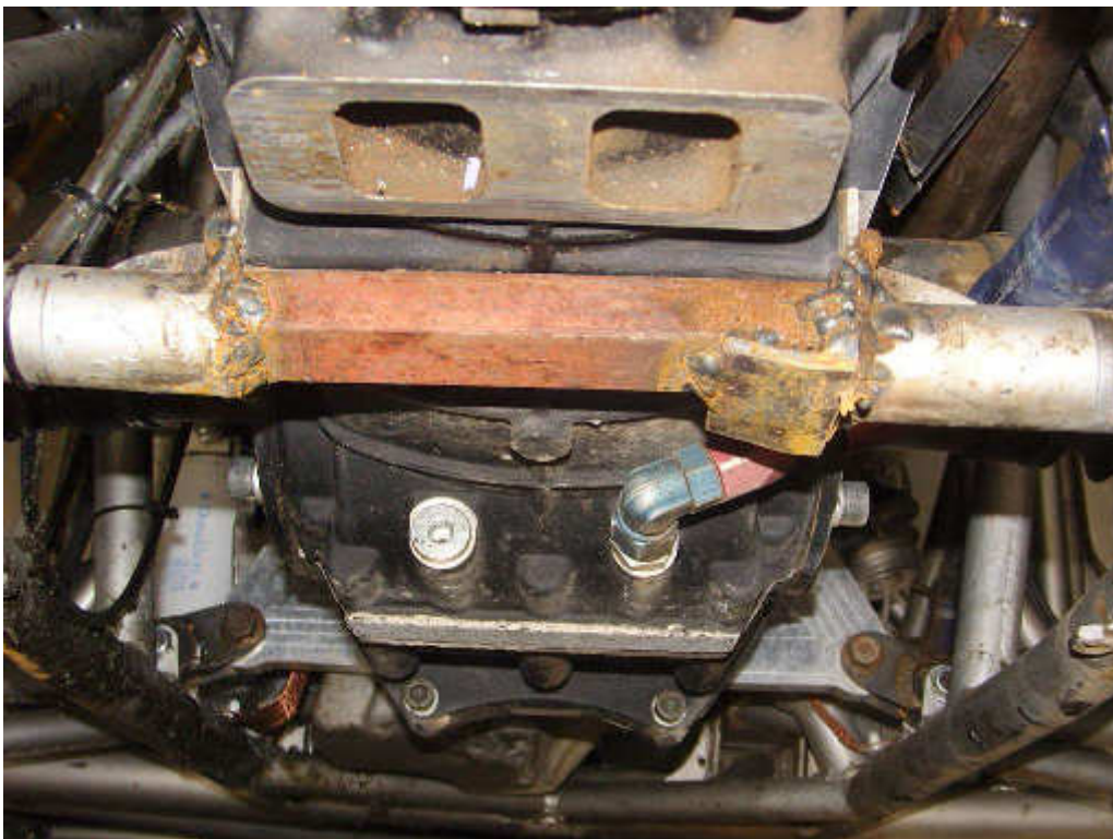
Figura 21 – Adição de material realizada durante a assistência do veículo em Fronteira
