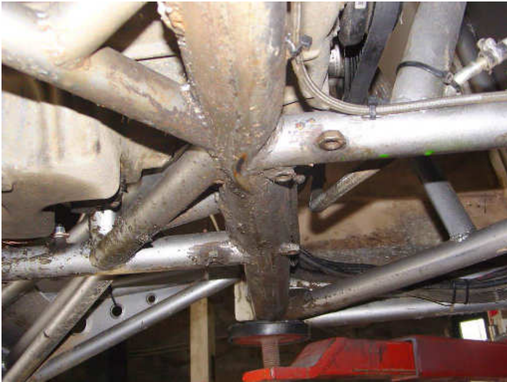
Figura 27 – Barra deformada responsável pela ligação dos elementos de transmissão e de suspensão traseira ao chassis
