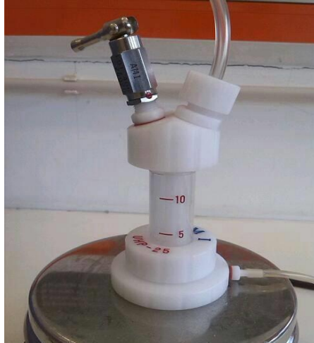
Figura 3.15. Equipamento de filtração utilizado no estudo da eficácia da membrana polimérica na remoção de arsênio.
