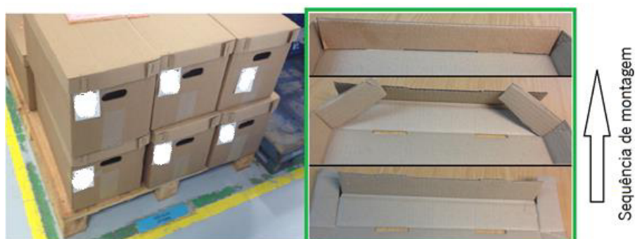
Figura 17 - Comparação entre tampa com agrafos e tampa automontável (retirado de Anexo 12)
