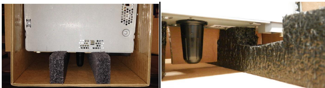
Figura 4.20 - Proteção dos conectores do cliente F
