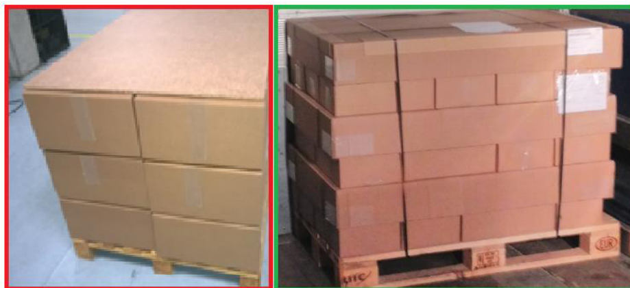
Figura 0.9 - Substituição de woodboards por uma tampa de cartão com 4 cantoneiras
