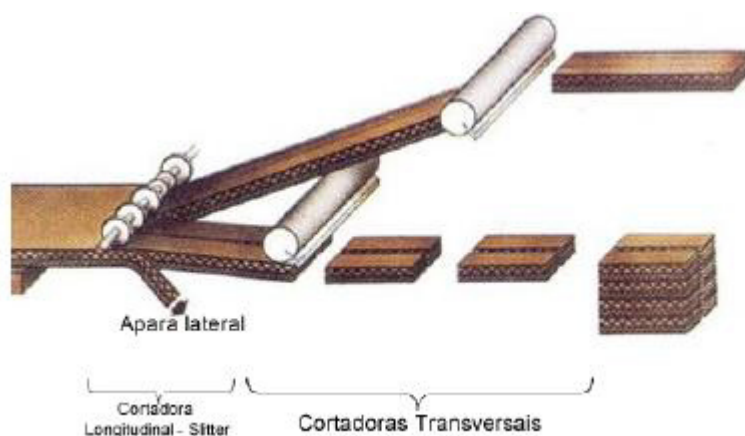
Figura 2.6 - Esquema simplificado do processo de produção de cartão canelado - zona seca (retirado de [9])
