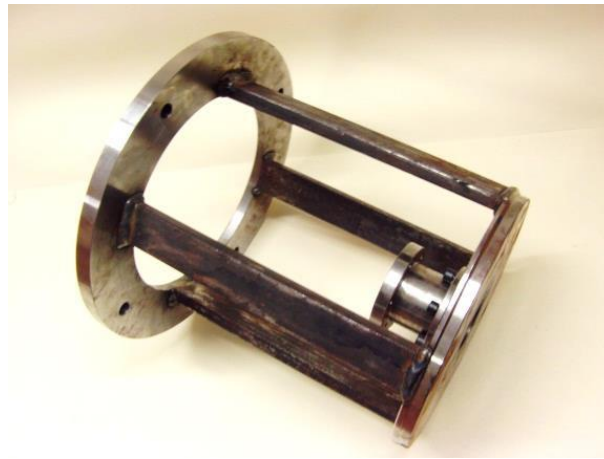
Figura 5.9 – Sistema de acoplamento entre o motor e o gerador.
