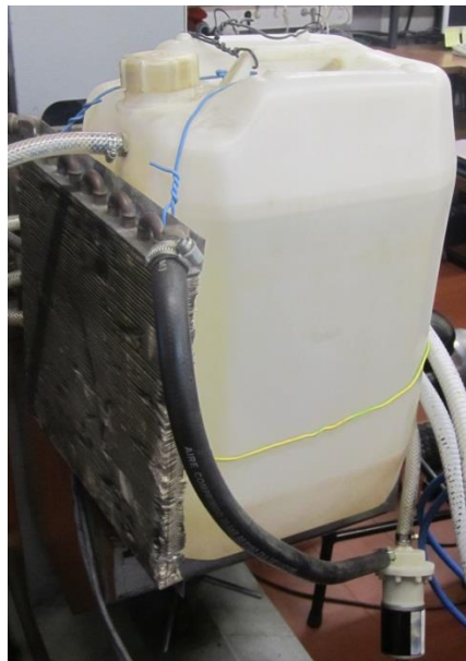
Figura 5.12 – Sistema de refrigeração do gerador.
