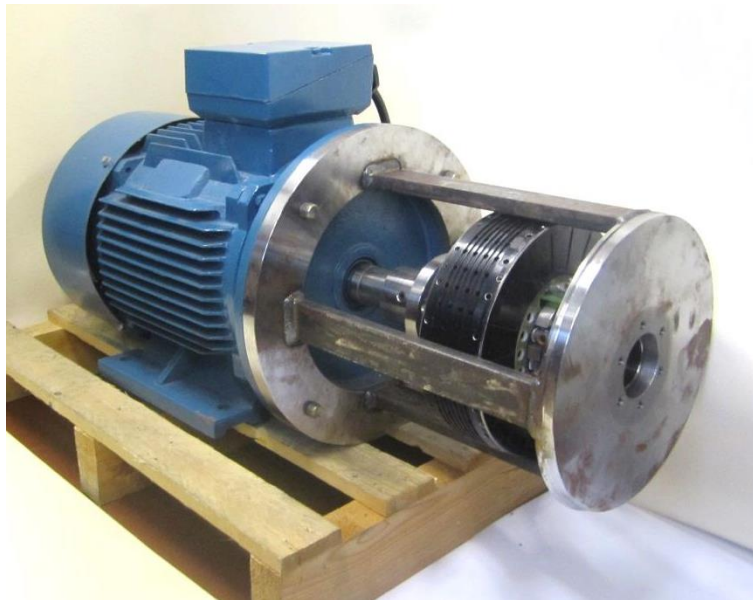
Figura 5.10 – Gerador elétrico mecanicamente acoplado ao motor de indução.
