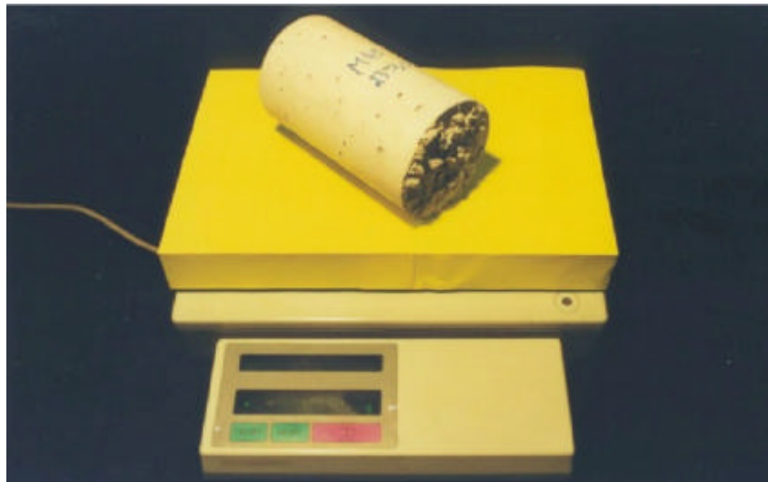
Figura 6.12 - Fotografia dos provetes na balança.
