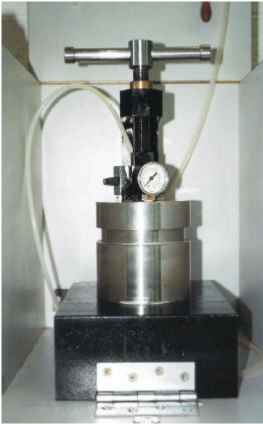
Figura 6.7 e 6.8 - Fotografias do Permeâmetro de Leeds.
