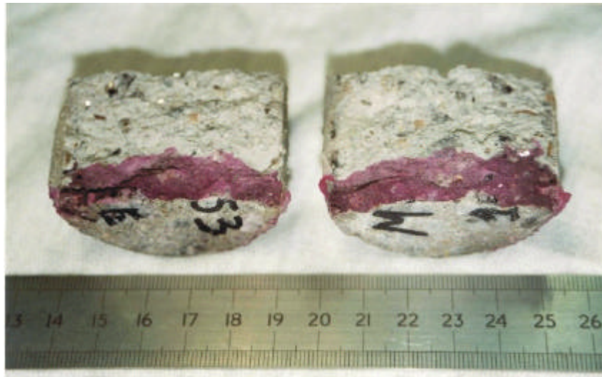
Figura 6.11 - Fotografia dos provetes abertos com fenolfetalaina.
