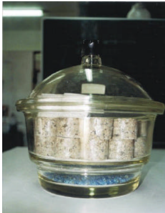
Figura 6.15 - Fotografia dos provetes no excicador.
