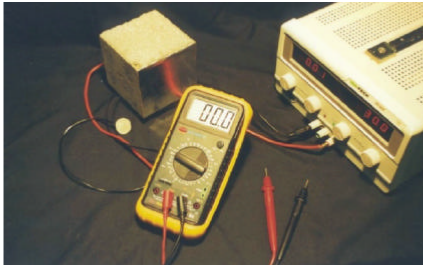
Figura 6.6 - Fotografia da fonte de alimentação de corrente contínua e o multímetro..
