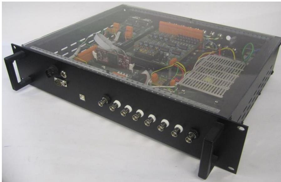
Figura 4.11 – *Rack* utilizada para integrar o sistema de controlo.
