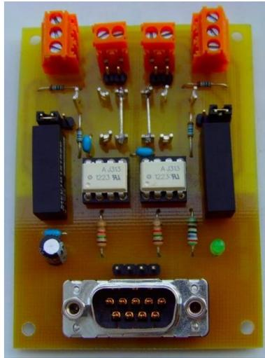
Figura 4.23 – Placa de *gate driver* com isolamento de 3 kV.
