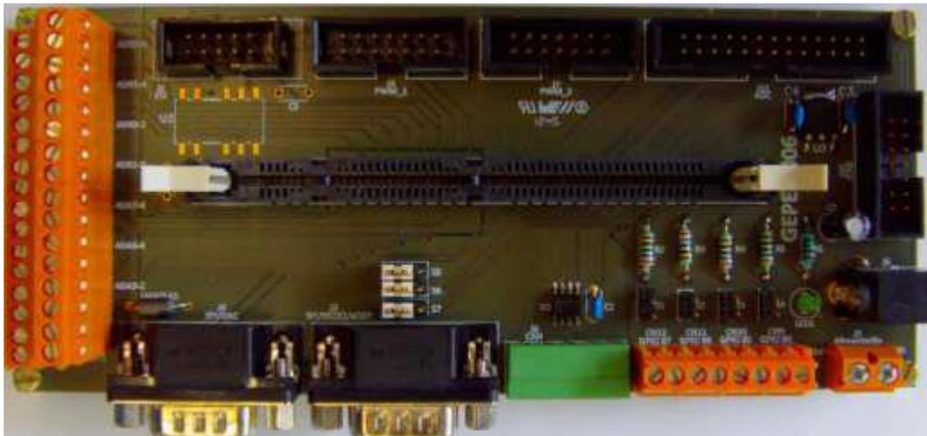
Figura 4.2 – Placa de adaptação de DSP.
