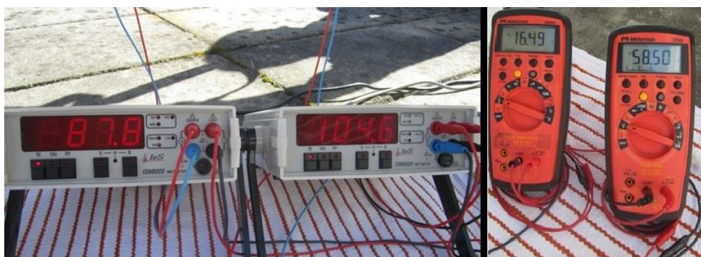
Figura 5.28 – Potência obtida com dois painéis fotovoltaicos ligados em série através dos seus conversores de potência dedicados quando é introduzida uma sombra no painel 2 (Wattímetro da esquerda: Potência painel solar 1, Wattímetro da direita: Potência total da instalação, Multímetro da esquerda: Tensão de saída do conversor 2, Multímetro da direita: Tensão saída conversor 1).
