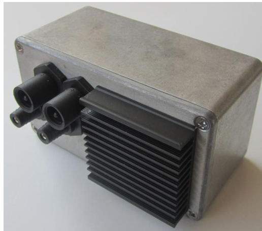
Figura 5.31 – Aspeto do protótipo perante a necessidade de um dissipador.
