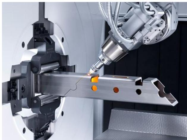
Figura 1 - Corte de uma peça em 3 eixos (Trumpf, 2015)
