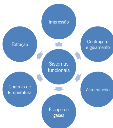
Figura 19: Sistemas funcionais de um molde Fonte: Brito, 2000
