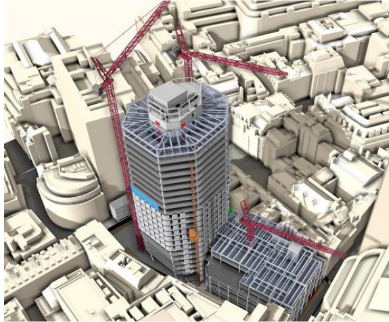
Figura 24 Simulação construtiva do One Angel Court (Synchro 2015a)
