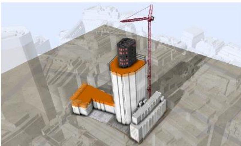
Figura 26 Piso em destaque a ser demolido (Synchro 2015a)
