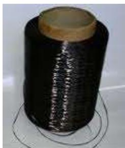
Figura 5- Roving de fibra de carbono [13]
