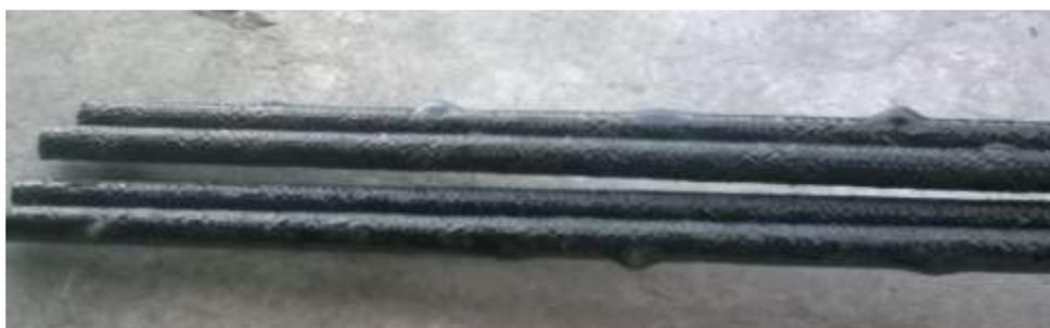
Figura 44- Varões entrançados em material compósito produzidos.
