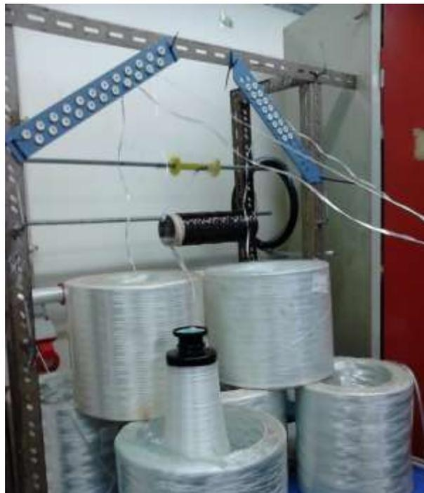
Figura 35- Sistema da colocação das fibras
