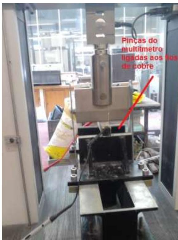
Figura 67- Pinças do multímetro ligadas aos fios de cobre para medir a resistência elétrica
