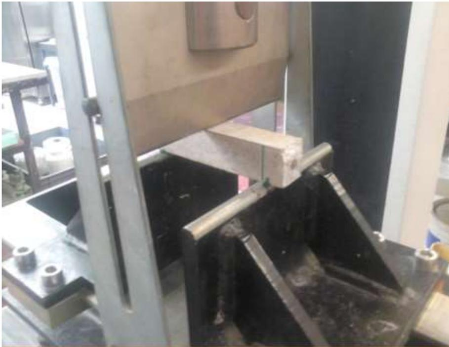
Figura 69- Ensaio de flexão três pontos do elemento estrutural com varão de aço
