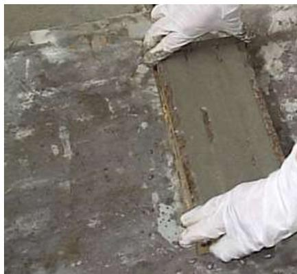
Figura 61- Molde com argamassa na mesa vibratória
