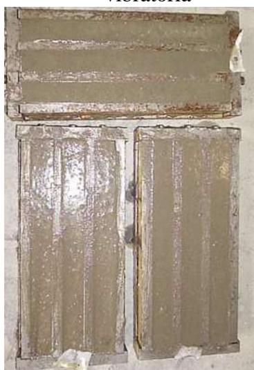
Figura 62- três moldes dos elementos estruturais finalizados (argamassa,BCR, Aço)
