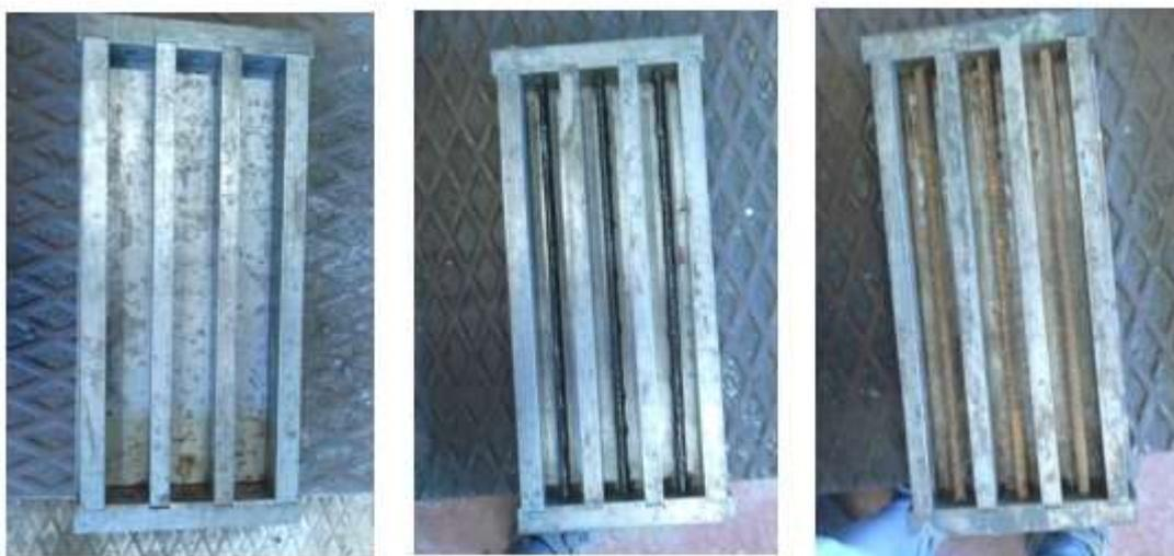
Figura 59- moldes com as três amostras preparados para encher com argamassa.
