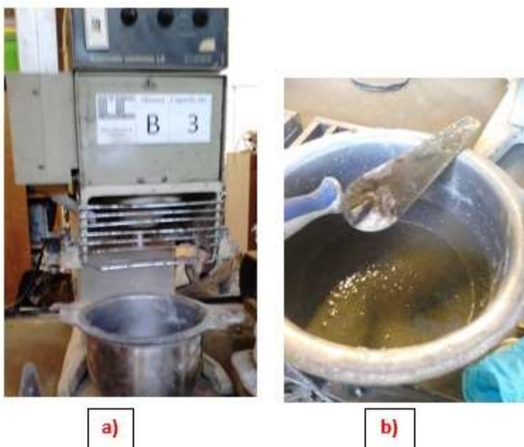
Figura 60- a) misturadora; b) mistura de argamassa
