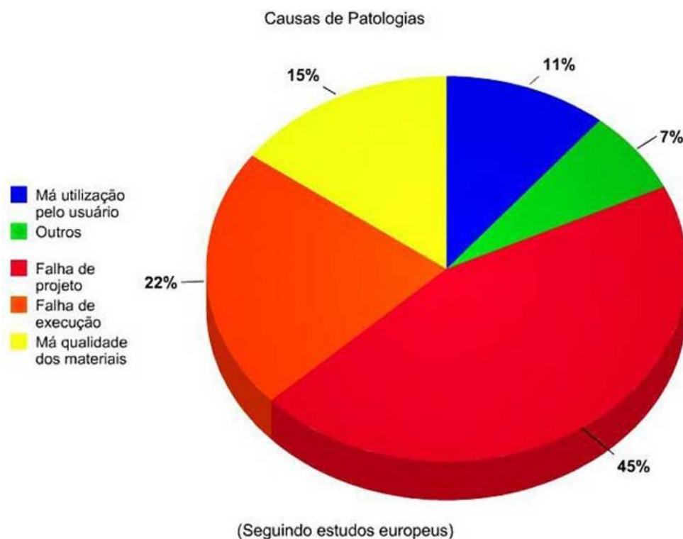
Gráfico 1 - Causas das patologias na Construção
