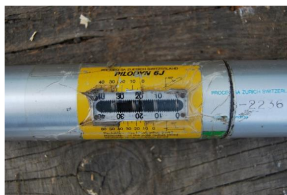
Figura 4.10 - Pilodyn: a) Equipamento; b) Exemplo de utilização; c) Escala de leitura
