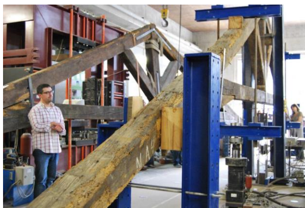
Figura 5.12 – Realização do ensaio de carga na estrutura original da Asna 2
