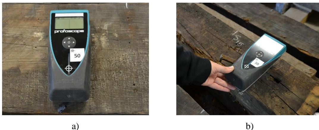
Figura 4.18 – Detetor de metais: a) equipamento; b) exemplo de utilização
