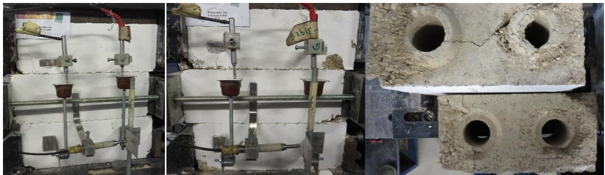
Figura 90: Modo de rotura dos prismas de junta seca com nível de compressão de 0,30 MPa.
