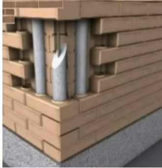
Figura 20: Colocação de argamassa e varões de aço(7).
