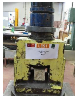
Figura 49: Ensaio de prismas de argamassa: a) ensaio de flexão em três pontos; b) ensaio de compressão.
