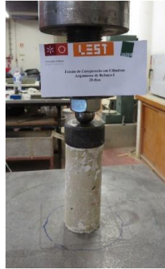
Figura 56: Esquema de ensaio para determinação da resistência à compressão das argamassas.
