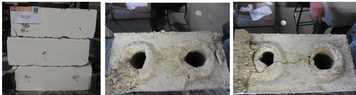
Figura 96: Modo de rotura dos prismas de junta argamassada com nível de compressão de 0,15MPa.
