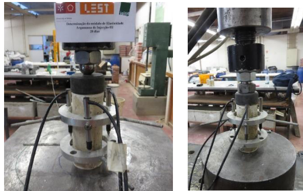
Figura 55: Esquema de ensaio para determinar o módulo de elasticidade dos cilindros de argamassa.
