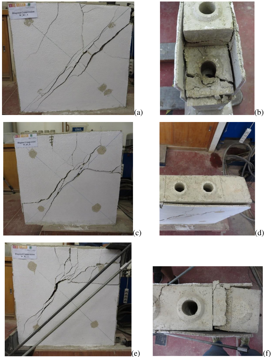
Figura 112: Modo de rotura de ensaio de resistência a compressão diagonal de paredes de junta seca com reforço de reboco armado; : (a) e (b) Parede W_R2_A; (c) e (d) Parede W_R2_B; (e) e (f) Parede W_R2_C;
