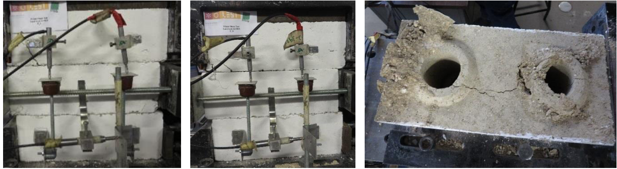
Figura 89: Modo de rotura dos prismas de junta seca com nível de compressão de 0,15 MPa.
