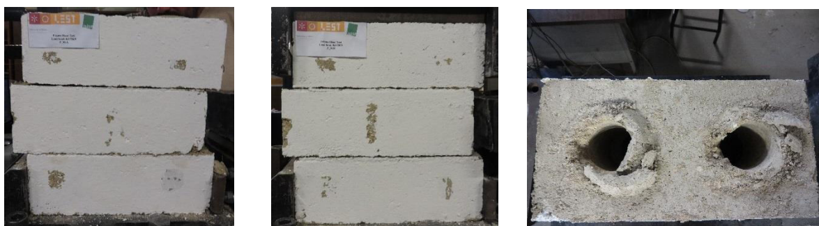
Figura 95: Modo de rotura dos prismas de junta argamassada com nível de compressão de 0,075 MPa.
