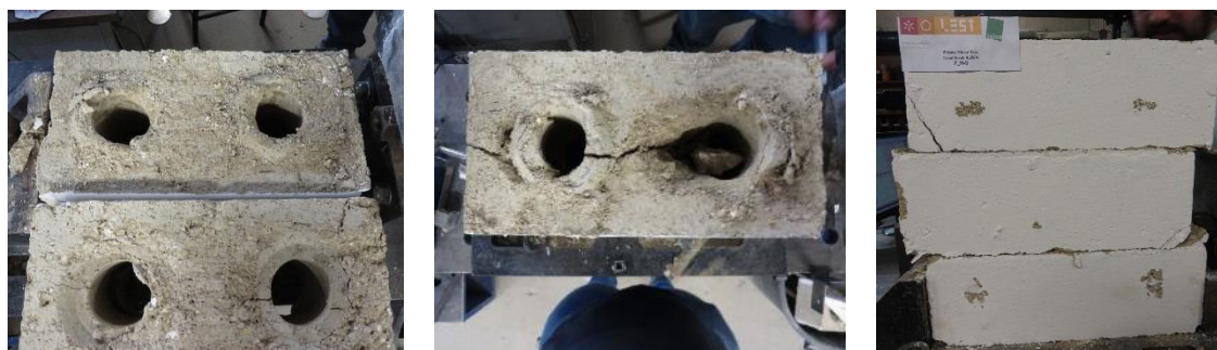
Figura 97: Modo de rotura dos prismas de junta argamassada com nível de compressão de 0,30 MPa.
