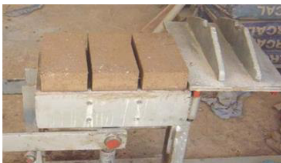
Figura 13: Prensa manual e BTC maciço (Senf, 2006).
