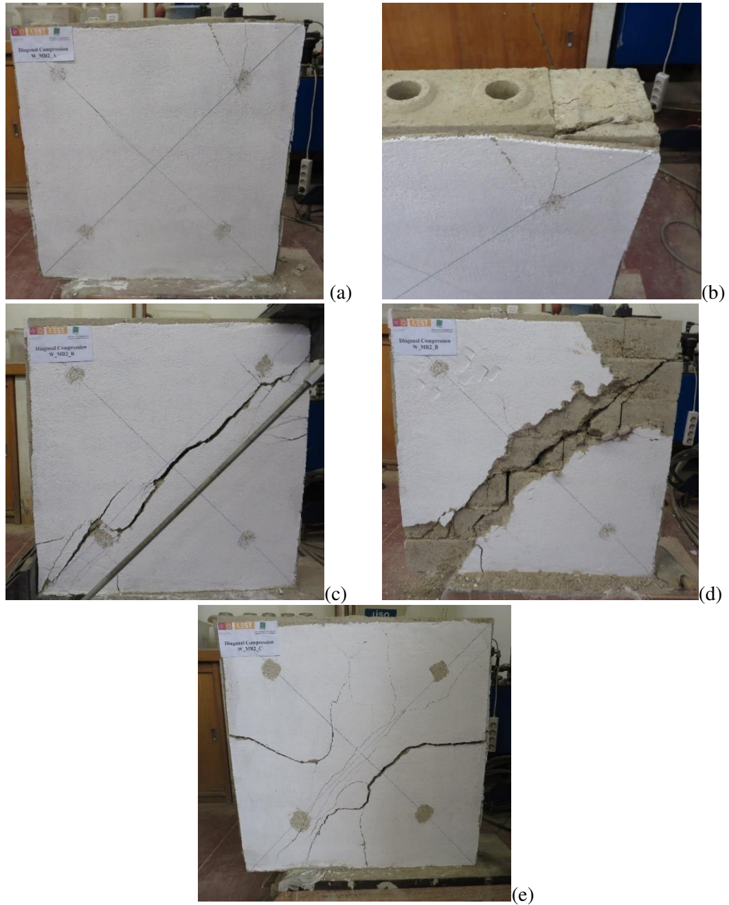
Figura 116: Modo de rotura de ensaio de resistência à compressão diagonal de paredes argamassadas com reforço de reboco armado: (a) e (b) Fissuração da parede W_M_R2_A; (c) e (d) Fissuração da parede W_M_R2_B; (e) Fissuração da parede W_M_R2_C.
