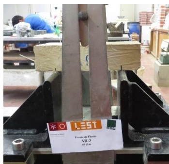
Figura 49: Ensaio de prismas de argamassa: a) ensaio de flexão em três pontos; b) ensaio de compressão.
