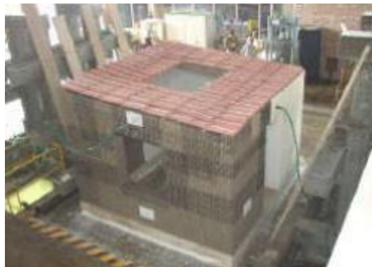
Figura 31: Modelo reforço com malha exterior de plástico (Torrealva & Vargas, 2005).
