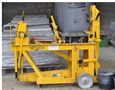
Figura 76: Prensa utilizada para o processo de fabrico dos BTC.
