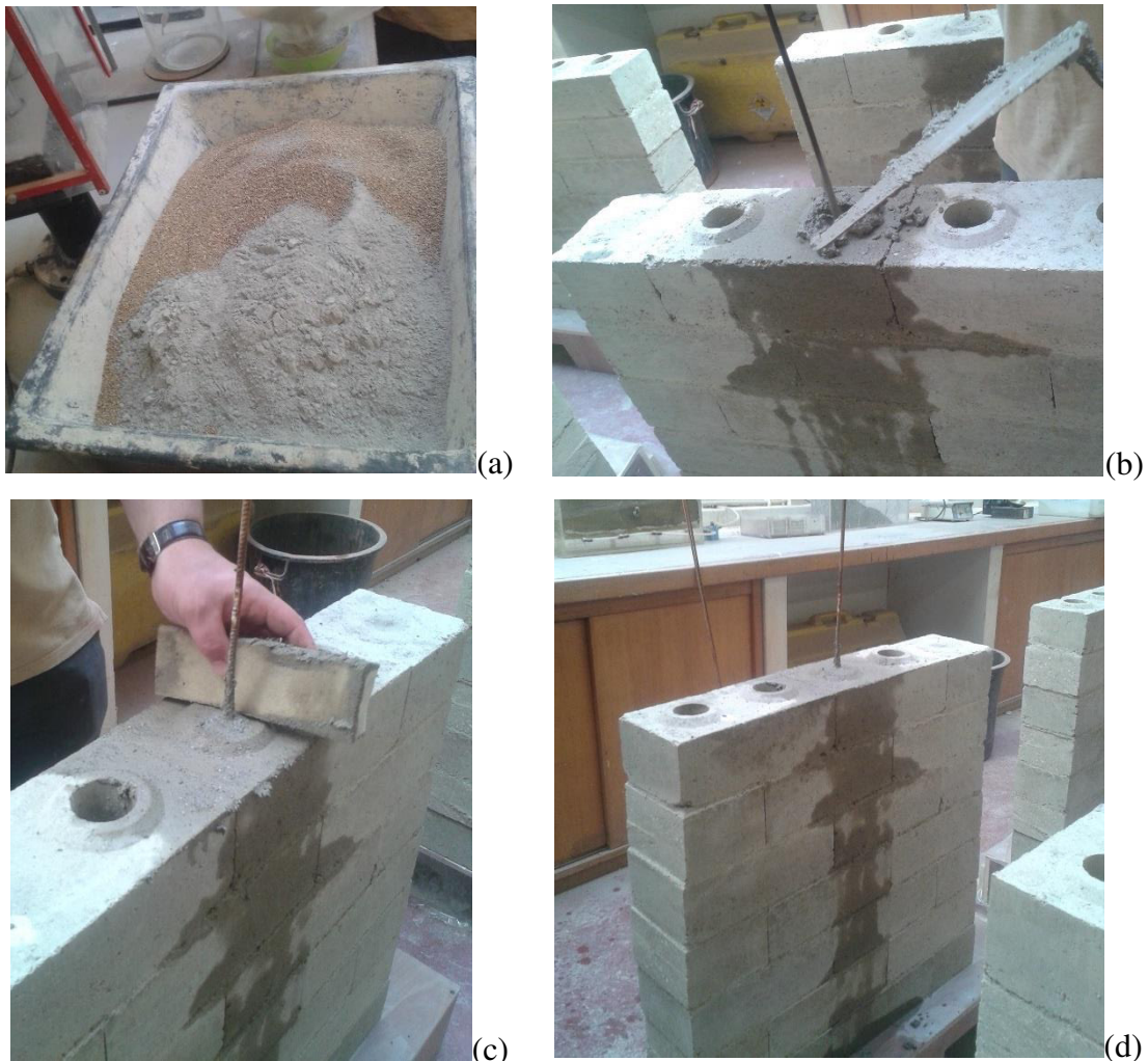
Figura 108: Processo de aplicação do reforço interno (reforço R1): (a) Preparação da argamassa de injeção; (b) Processo de injeção de argamassa e colocação de varão de aço no interior da parede; (c) Limpeza de excessos de argamassa; (d) Provete em processo de cura.
