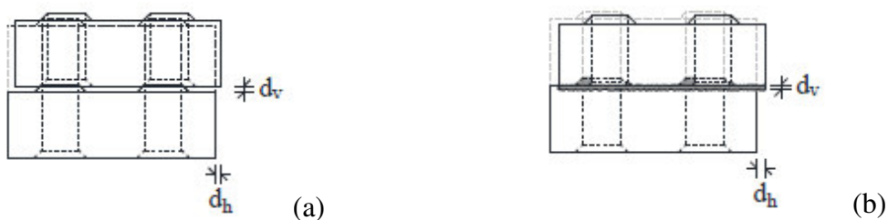
Figura 122: Modos de rotura para os diferentes confinamentos: (a) confinamento de 0,075MPa; (b) confinamento de 0,15 e 0,30MPa
