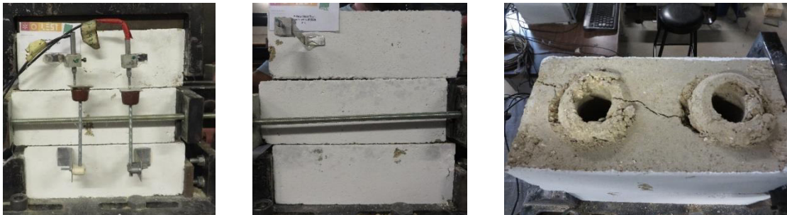
Figura 88: Modo de rotura dos prismas de junta seca com nível de compressão de 0,075 MPa.
