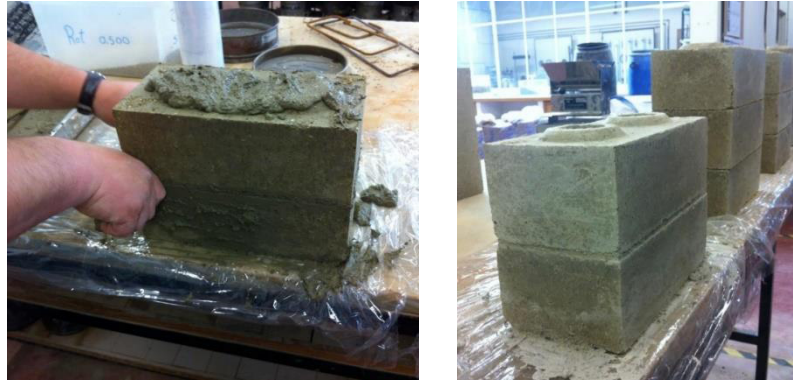
Figura 81: Processo de construção dos prismas.
