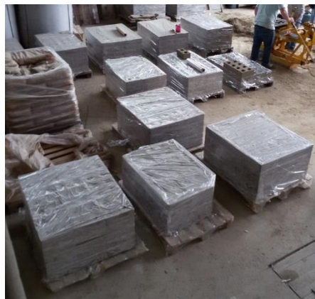
Figura 77: Colocação de película aderente e armazenamento de BTC.
