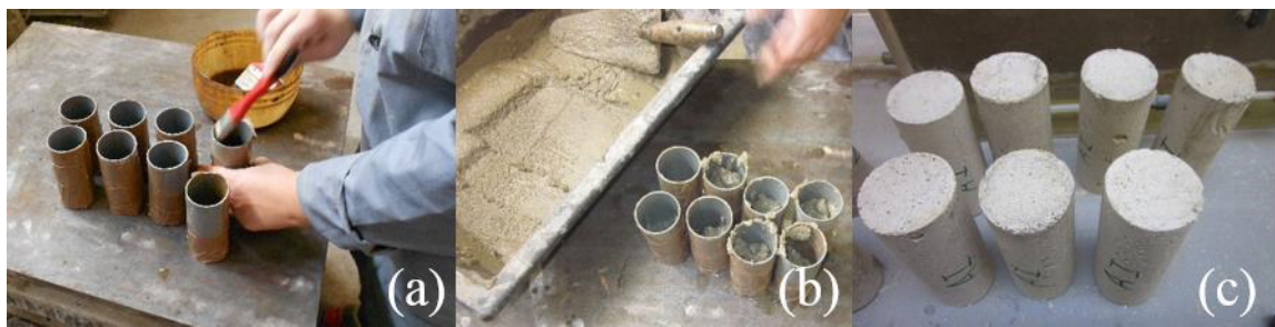
Figura 52: Processo de fabrico dos cilindros: (a) Colocação de óleo descofrante; (b) Colocação de mistura; (c) Provetes desmoldados.
