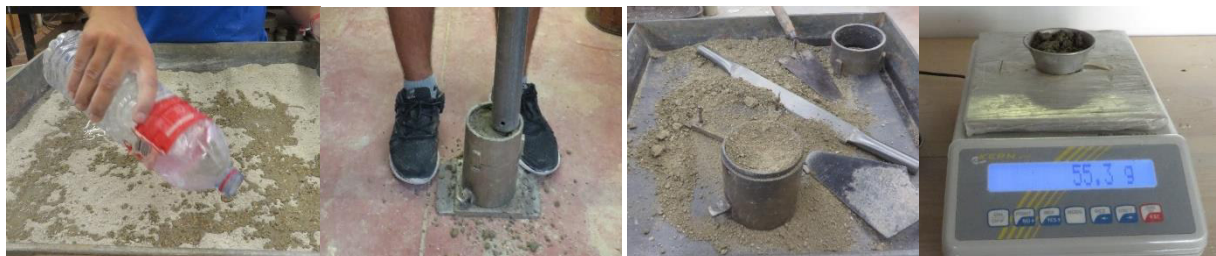
Figura 38: Procedimento de ensaio de compactação de Proctor.
