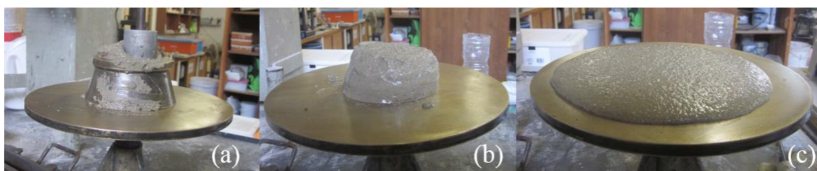
Figura 44: Ensaio de espalhamento: (a) compactação da argamassa; (b) espalhamento da argamassa; (c) medição do diâmetro.
