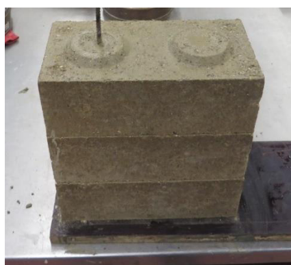
Figura 42: Fabrico dos provetes de análise e inspeção visual: a) aplicação de argamassa de injeção b) aplicação da argamassa de reboco.
