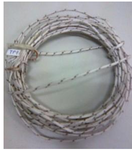
Figura 4. 2 : Termopares em tipo T em cobre/constantan
