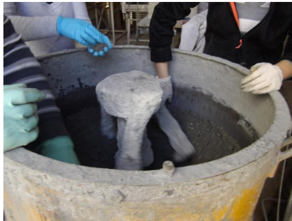
Figura 3. 6: Mistura dos constituintes dos BTC
