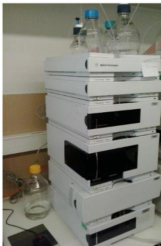
**Figura 2.2:** Sistema cromatográfico líquido de alta eficiência, marca *Agilent Technologies* do sector de cromatografia líquida do IVDP.IP
