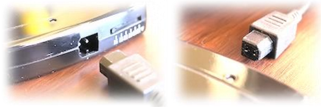
Figura 2 - Sistema Poka Yoka de uma ficha de computador ("The Toyota System Tips & Information," 2011)
