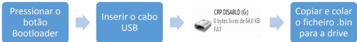
Após este passo ter sido realizado é necessário proceder a um *reset* da placa e então a aplicação é executada. Para executar este passo basta conectar diretamente um botão que realize o contacto entre o *pin reset* e a massa quando pressionado isto porque o *pin reset* funciona em *active-low*.
