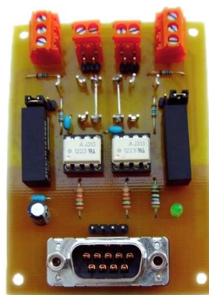
Figura 5.2 – Placa de drive dos IGBTs (desenvolvida no GEPE).
