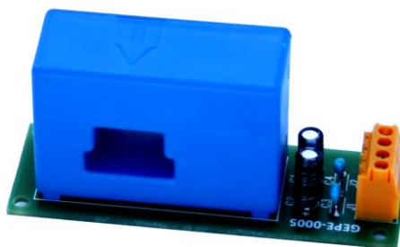
Figura 5.18 – Placa do sensor de corrente (desenvolvida no GEPE).
