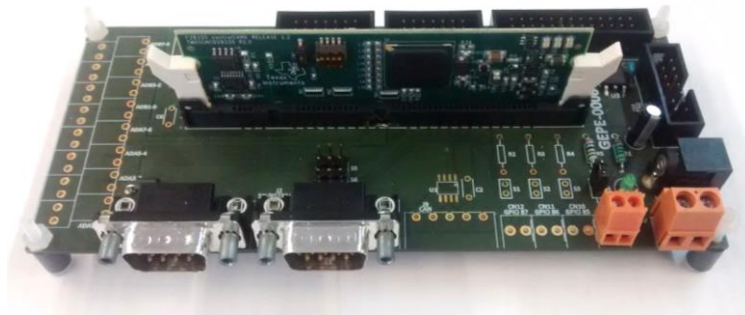
Figura 5.14 – DSP e respetiva placa de adaptação (desenvolvida no GEPE).
