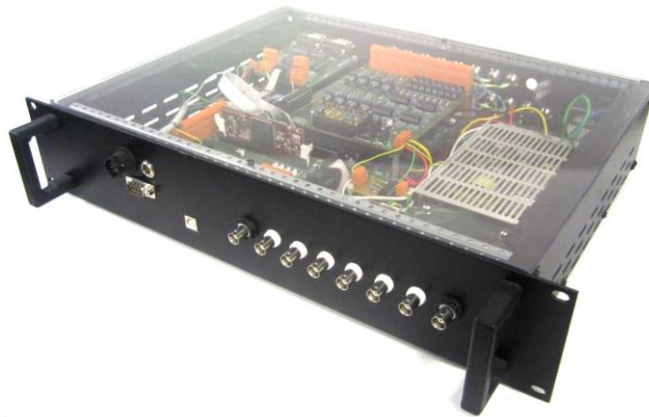
Figura 5.12 – Hardware do sistema de controlo integrado numa rack (desenvolvida no GEPE).
