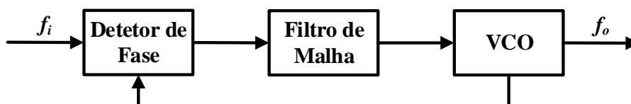
Figura 3.12 – Diagrama de blocos simplificado de uma PLL.
