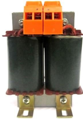
Figura 5.10 – Bobina utilizada nos filtros de saída.
