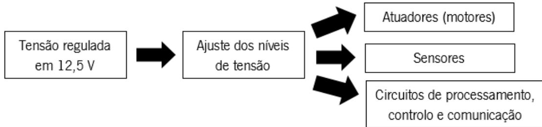
Figura 71 - Arquitetura do sistema responsável pelo fornecimento adequado de energia ao sistema de controlo da locomoção.
