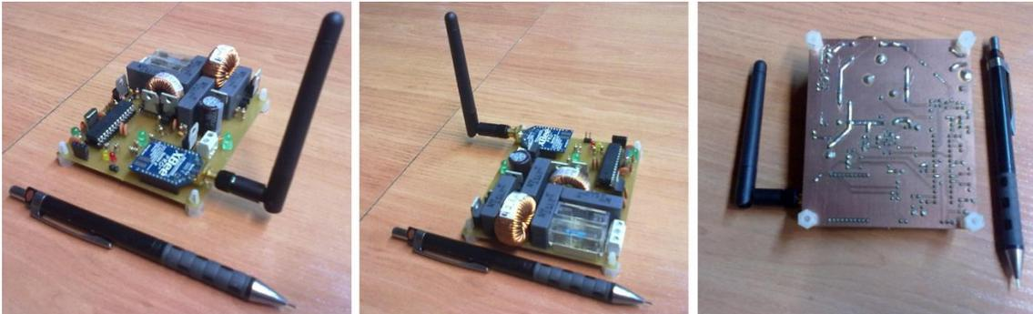
Figura 99 - Placa de circuito impresso que implementa todo o sistema responsável pela gestão otimizada da energia.
