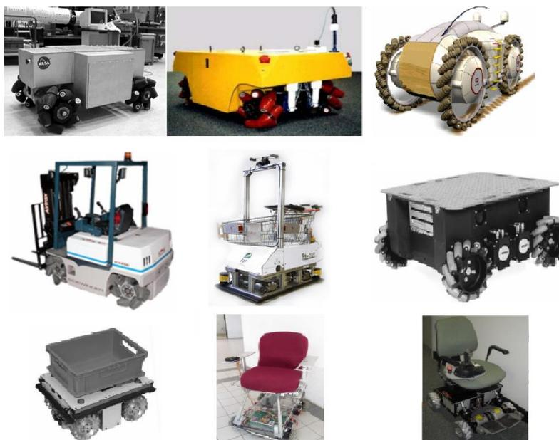
Figura 37 - Exemplos de aplicações para o sistema de direção baseado em 4 rodas *Mecanum* motrizes (adaptado de [5]).
