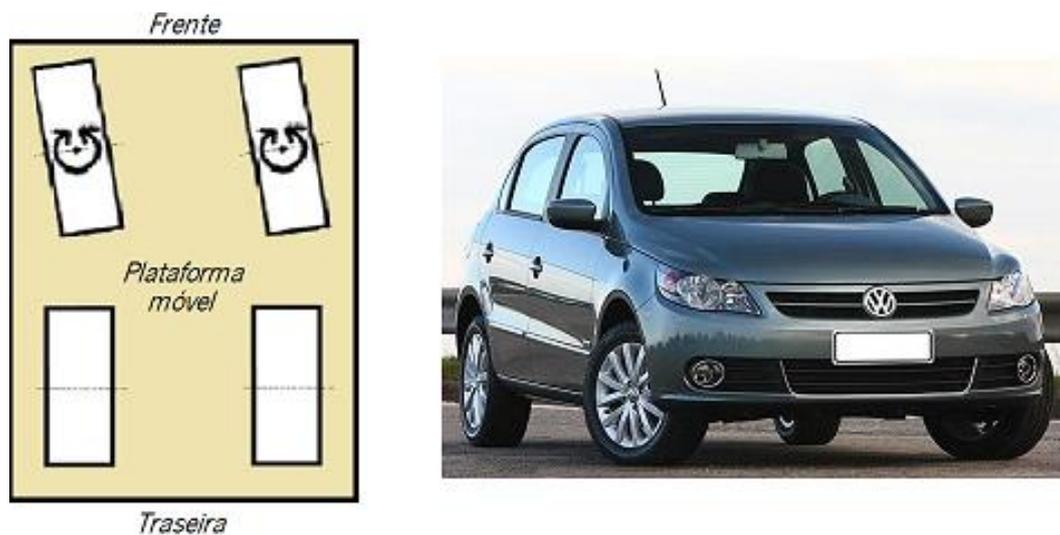
Figura 31 - À esquerda apresenta-se o esquema de um sistema de direção composto por duas rodas *Castor* dianteiras e duas rodas fixas *standard* traseiras. Esta configuração pode ser encontrada em praticamente todos os automóveis [42].
