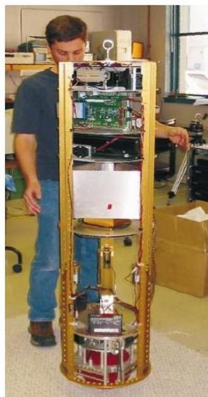
Figura 20 - O *CMU Ballbot* é um exemplo de um robô móvel que utiliza uma roda esférica motriz [34].
