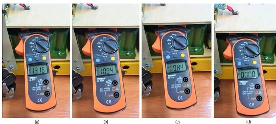
Figura 92 - Diferentes valores de corrente de carregamento (em amperes) do módulo de ultracondensadores.
