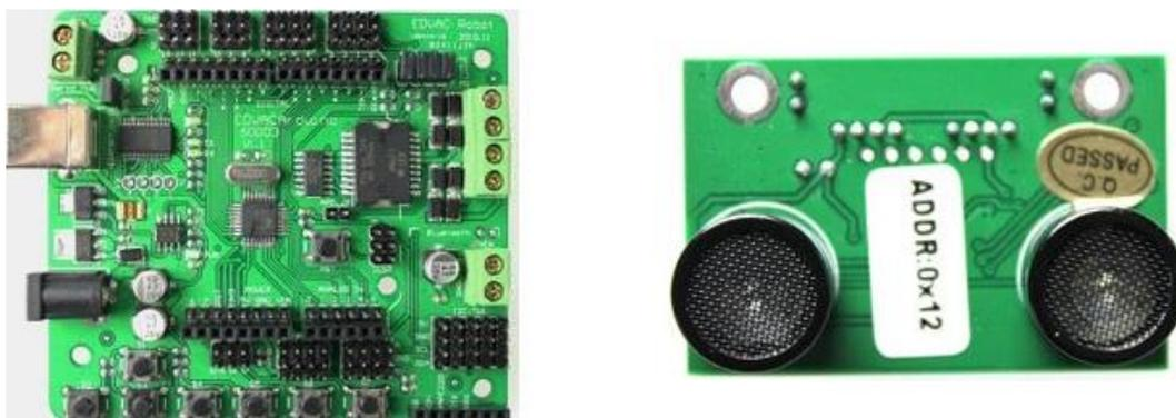
Figura 106 - Placa de circuito impresso com circuitos de controlo e *interface* cujo microcontrolador é o Atmel ATmega 328P e sensor de distância baseado em ultrassons. Ambos vinham incluídos com a plataforma móvel omnidirecional [82].
