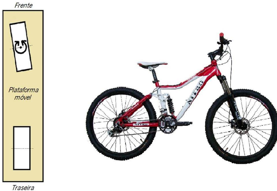
Figura 23 - À esquerda apresenta-se o esquema de um sistema de direção composto por uma roda fixa *standard* motriz e uma roda *Castor* passiva. A bicicleta é uma das aplicações possíveis para esta configuração [36].
