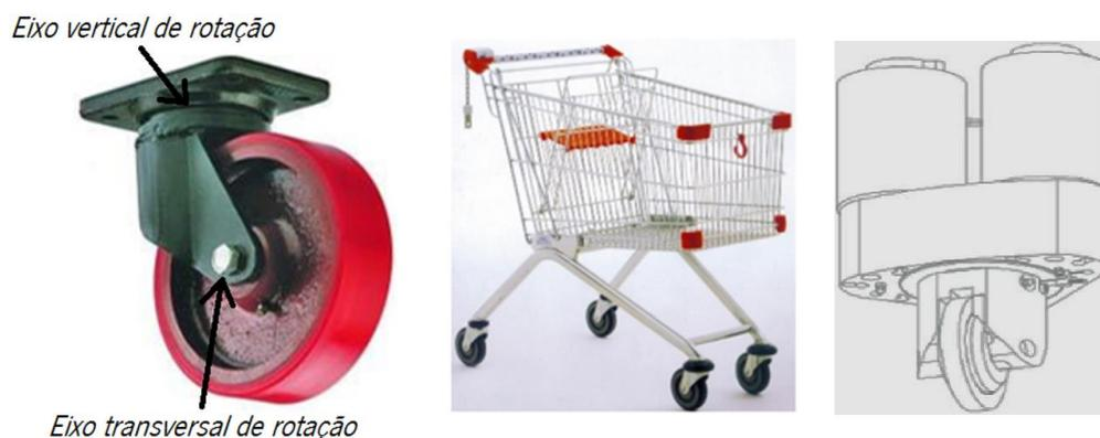
Figura 9 - À esquerda apresenta-se uma roda *Castor* passiva (adaptado de [20]), ao centro uma aplicação para esta categoria de rodas: o carrinho de compras do supermercado [21] e à direita uma roda *Castor* motriz com 2 atuadores [1] – um por cada grau de liberdade.
