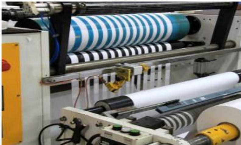
Figura 14: Máquina de *Ribbon* de Tecido.
