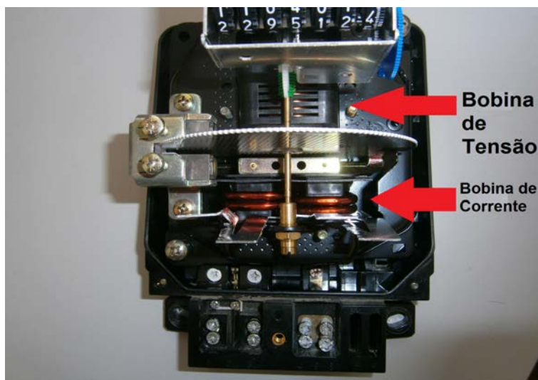
Figura 6.1: Bobinas de corrente e tensão
