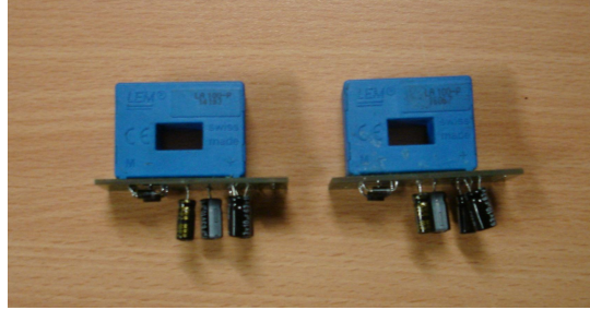
Figura 6.2: PCB para leitura das correntes do sistema elétrico.
