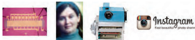
Figura 14 – Da esquerda para a direita: CCD ( charge-coupled device ), desenvolvido em 1969 na Bell Labs (EUA); imagem captada com a vídeo-câmara digital de Michael F. Tompsett (1972); primeira câmara fotográfica digital, inventada por Steven J. Sasson em 1975 (pesava 3,6 kg e tinha 0,01 megapixels); logotipo do Instagram
