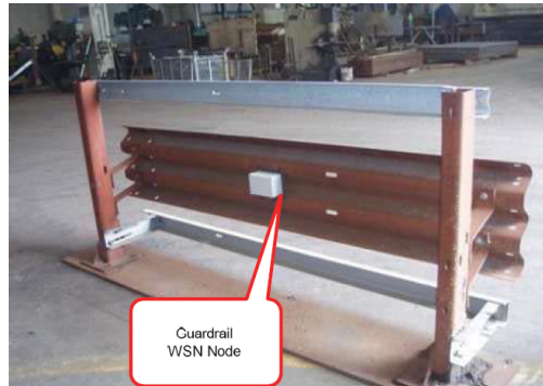
Figura 2.9: Nó sensor aplicado numa barreira [8].
