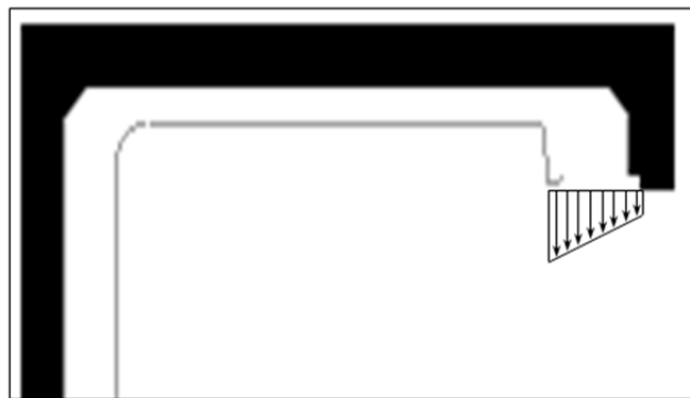
Figura 3.20 - Perfil ideal de velocidades na grelha de insuflação
