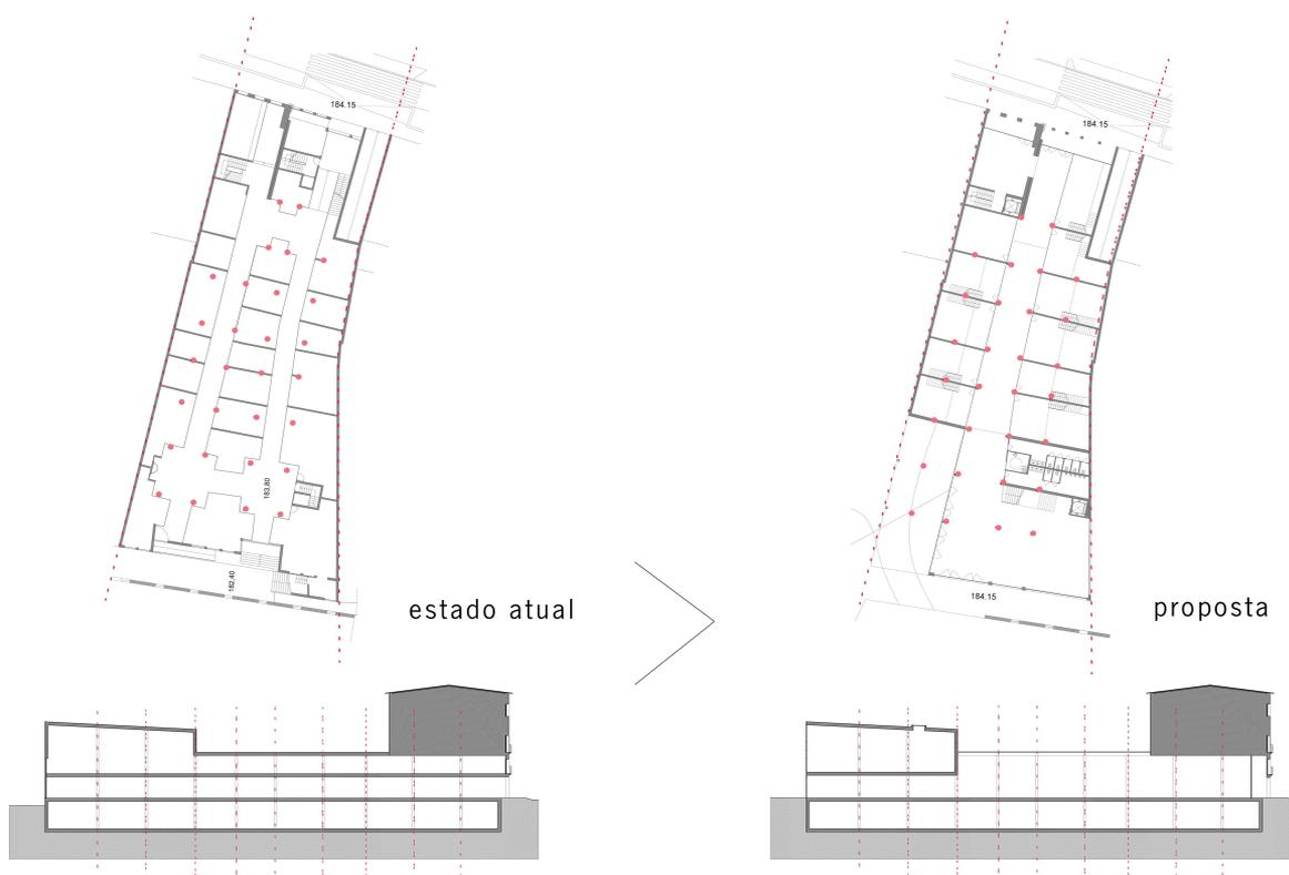
Figura 44 - Planta e perfil longitudinal: estado atual e proposta de intervenção. Representação esquemática da métrica estrutural e da volumetria do edifício do centro comercial que no processo de reabilitação foram reaproveitadas.
