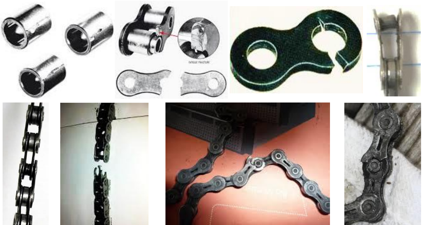
Fig. 21 Exemplos de falhas e avarias em sistemas de transmissão por correntes.
