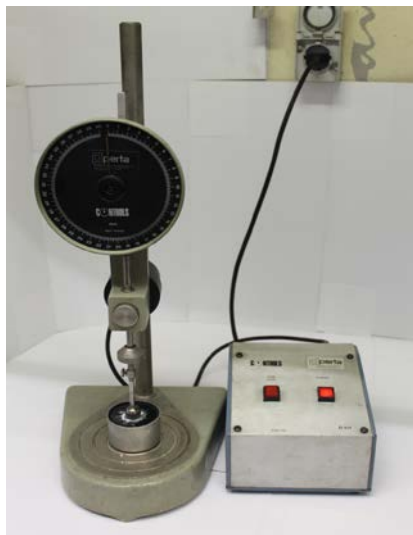
Figura 3: Equipamento utilizado no ensaio de resiliência (penetração e recuperação)
