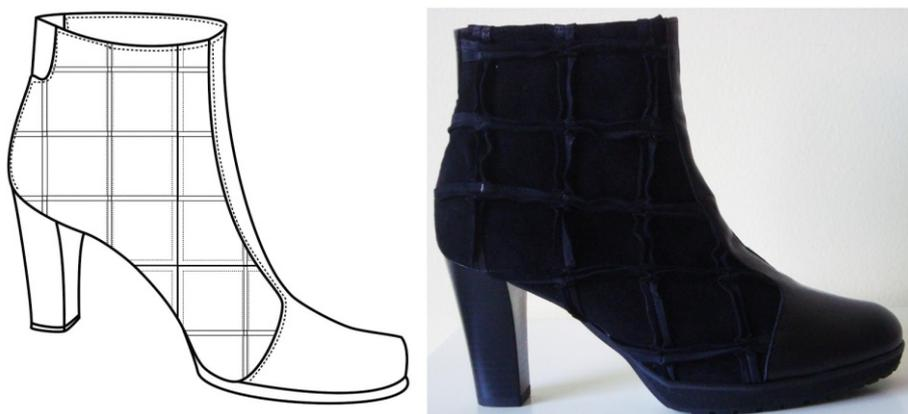
**Figura 3:** Desenho técnico e protótipo final da Bota “upcycled” em pele residual. **Fonte:** autoras
