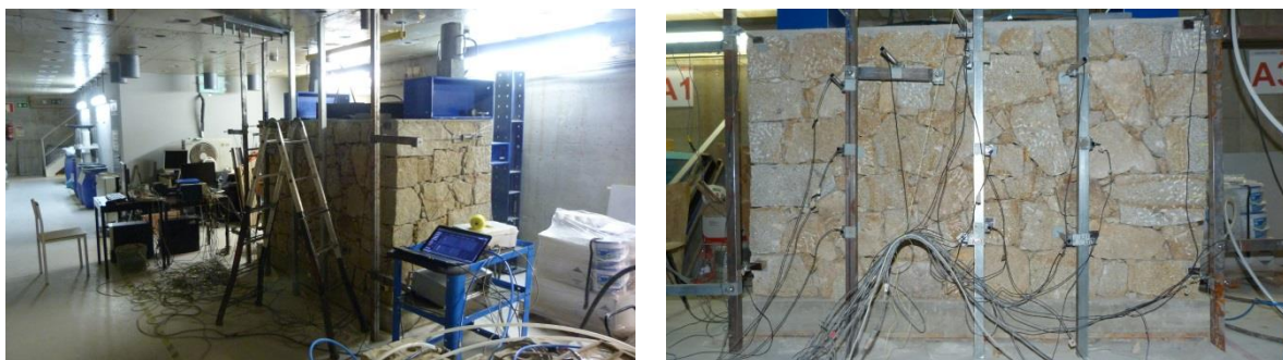
Fig. 6 – Setup do ensaio e posicionamento dos LVDTs
