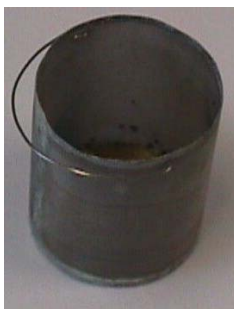
Figura 4.2 Cesto utilizado para a transferência da biomassa entre as soluções de trabalho.
