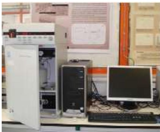
**Figura 3.7** - Cromatógrafo iônico usado para identificar os produtos das eletrólises.
